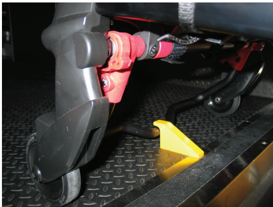
Figur 5 – Säkerhetsstången kopplas till fordonets säkerhetskrok
