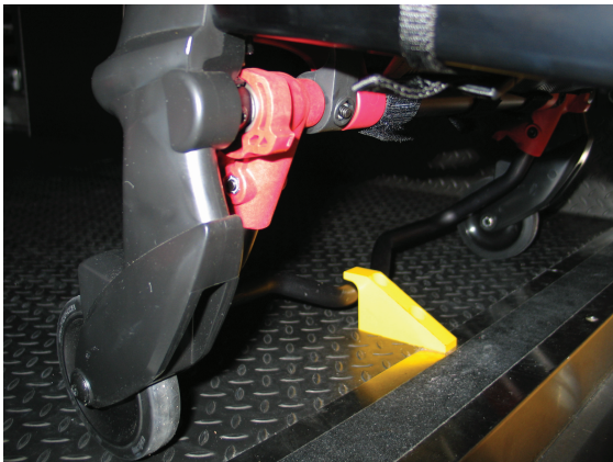
Figure 7 – Barre de sécurité fixée en place dans le crochet de sécurité du véhicule
