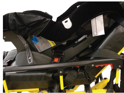
Ábra 31 – Rögzítse a derékbekötőt
