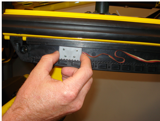
Obrázok 12 – Úprava výšky ľavého snímača
