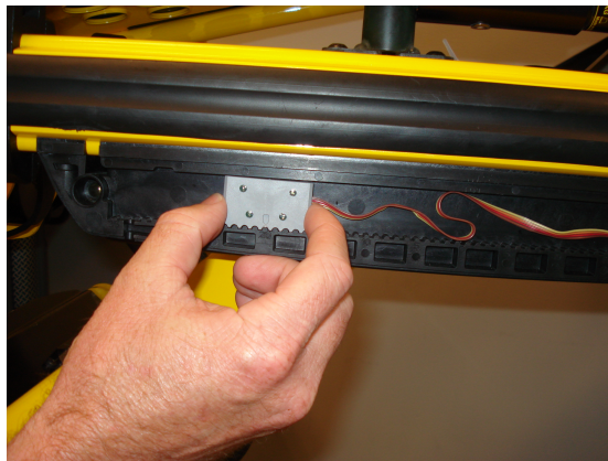
Rysunek 12 – Wyreguluj ustawienie lewego czujnika wysokości
