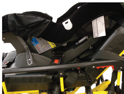
Obrázok 31 – Zabezpečenie pásového zadržiavacieho popruhu
