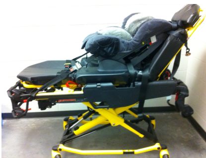
Figura 32 – Fijación a las barras de elevación del extremo de los pies
