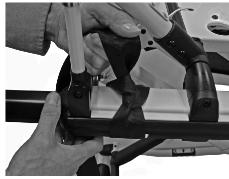
Ábra 19 – A bekötőöv rögzítése az ágyhoz
