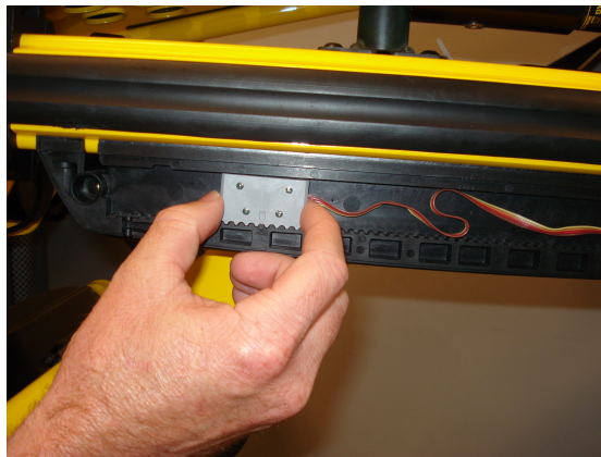
Obrázek 12 – Upravte nastavení levého senzoru výšky
