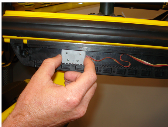
Slika 12 – Podesite visinu lijevog senzora
