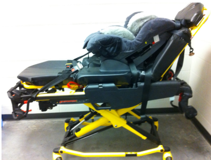
図 32 – 足側端部の持ち上げバーへの取り付け
