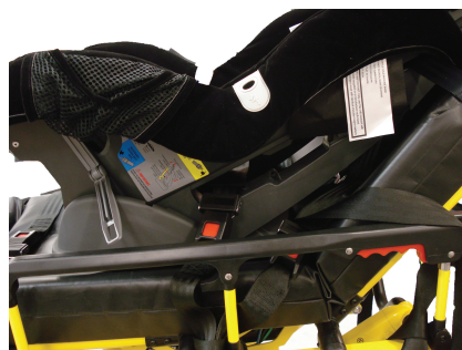
Рисунок 31 – Закрепите поясной фиксирующий ремень
