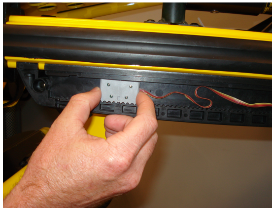
Abbildung 12 – Linke Sensorhöhe anpassen
