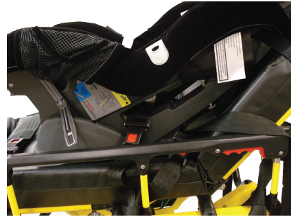
Kuva 31 – Kiinnitä vyötärön kiinnitin
