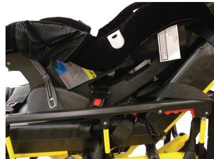
Figura 31 – Fije la sujeción de la cintura
