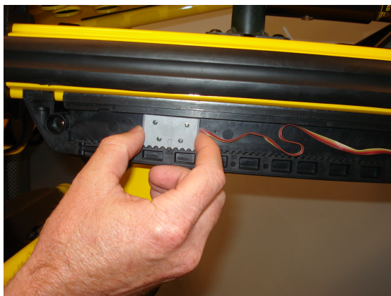
Afbeelding 12 – Hoogte linker sensor afstellen
