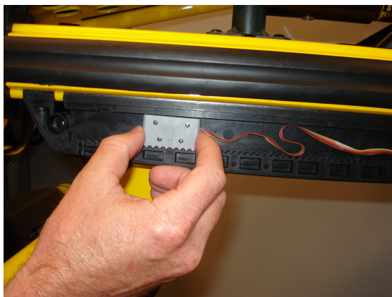
Slika 12 – Prilagoditev višine levega senzorja
