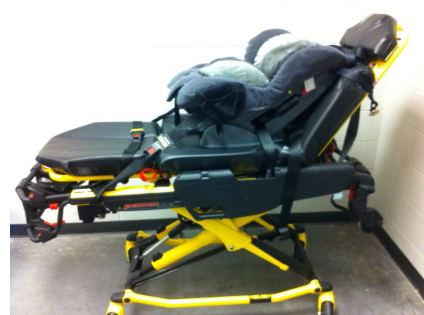
図 33 – 外側のレールへの取り付け
