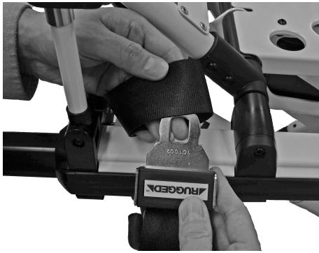
Afbeelding 17 – De veiligheidsriem om het frame van de brancard heen slaan
