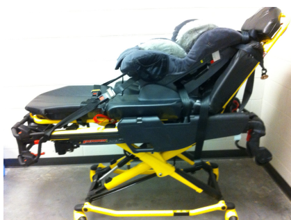
Obrázok 32 – Upevnenie k zdvíhacím tyčiam na nožnom konci
