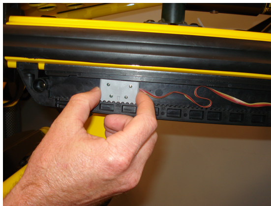
図 12 - 左側のセンサーの高さの調整
