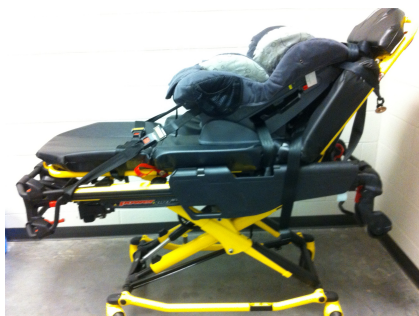
Рисунок 32 – Крепление к поручням для подъема ножного конца каталки
