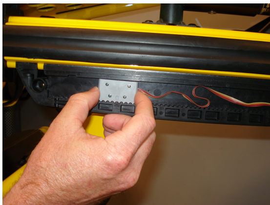
Figura 12 – Regolare l'altezza del sensore sinistro
