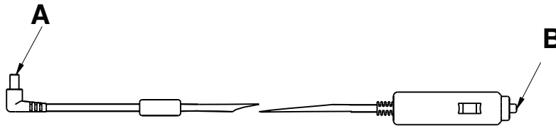
Figure 11 – Câble automobile de 12 V CC
