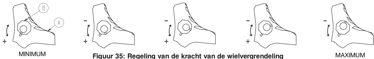
Figuur 35: Regeling van de kracht van de wielvergrendeling
