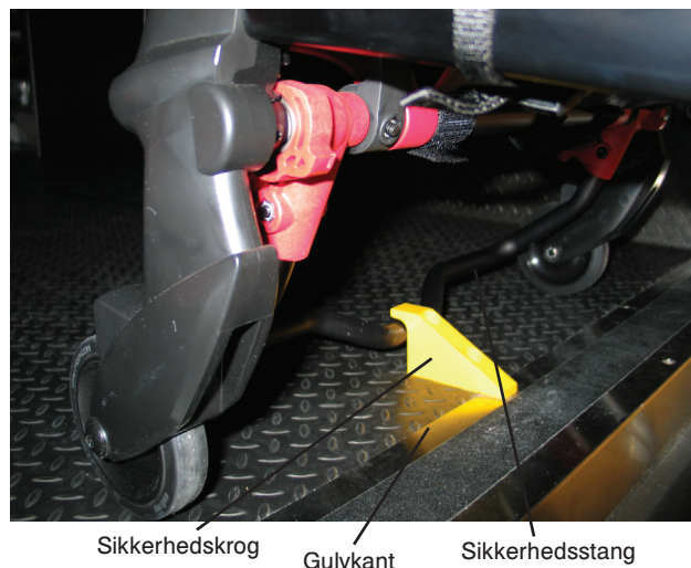
Figur 13: Sikkerhedsstangen griber fat i sikkerhedskrogen
