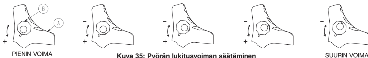
Kuva 35: Pyörän lukitusvoiman säätäminen
