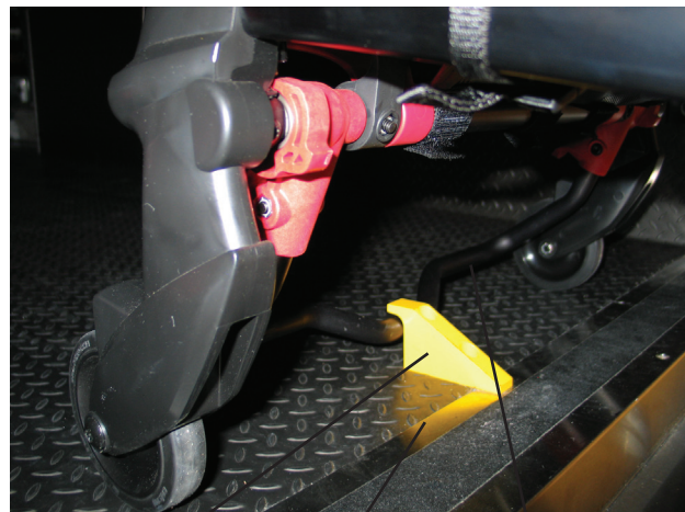
Abbildung 13: Sicherheitsbügel klinkt in Sicherheitshaken ein
