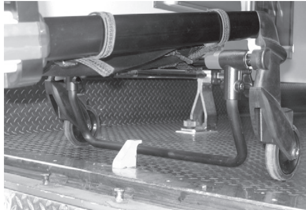
Abbildung 14: Sicherheitsbügel klinkt in Sicherheitshaken ein
