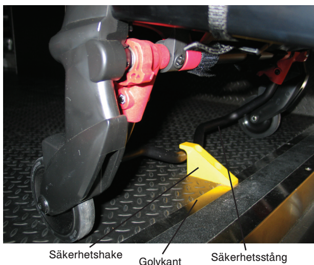
Figur 13: Säkerhetsstången ihopkopplad med säkerhetshaken
