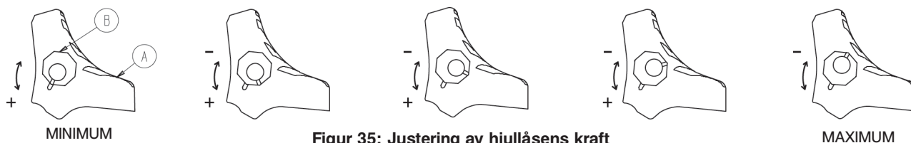
Figur 35: Justering av hjullåsens kraft
