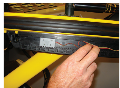
Figure 4.4 : Fixation des câbles
