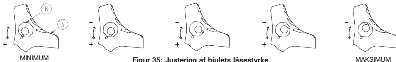
Figur 35: Justering af hjulets låsestyrke
