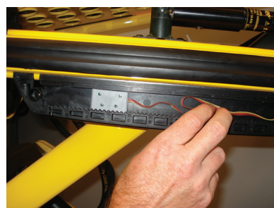
Figuur 4.4: Kabels vastzetten
