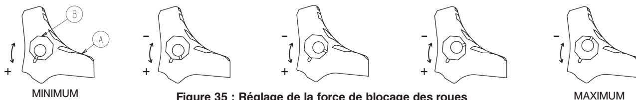
Figure 35 : Réglage de la force de blocage des roues
