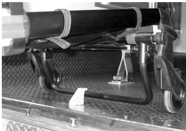
Figura 20: Barra de segurança a engatar no gancho de segurança
