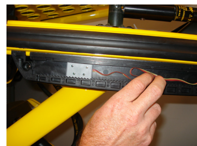
Figure 7 : Fixation des câbles
