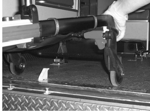
Figura 22: Desenganche de la barra de seguridad
