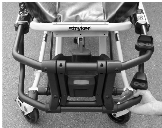
Figura 25: Maniglia di rilascio manuale di riserva
