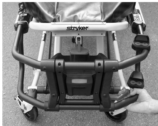
Obr. 25: Záložní ruční uvolňovací ovladač
