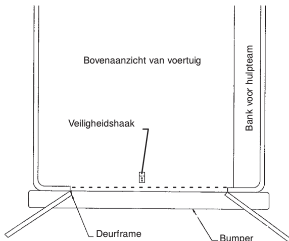
Afbeelding 16: Plaatsing van de veiligheidshaak (uitsluitend ter referentie)
