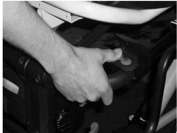
Figure 21 : Appuyer sur le bouton de repliement
