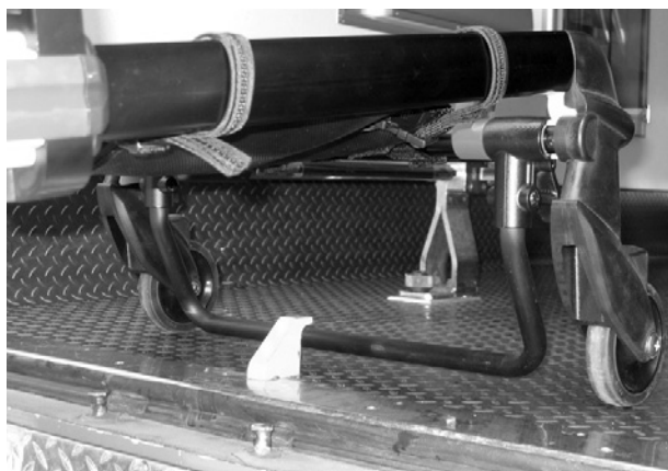
Figur 20: Säkerhetsstången ihopkopplad med säkerhetshaken
