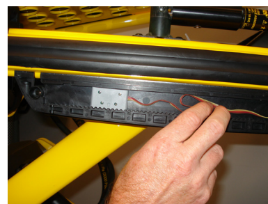
Figura 7: Sujeción de los cables
