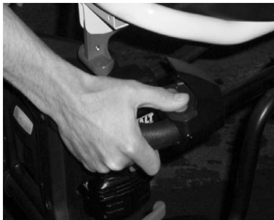
Afbeelding 23: Op de uitschuifknop drukken
