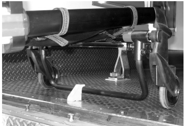
Kuva 20: Turvatangon kiinnittyminen turvakoukkuun
