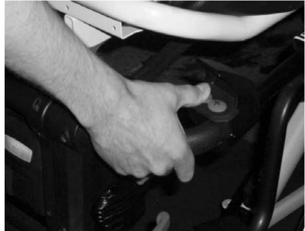
Figur 21: Tryck på infällningsknappen
