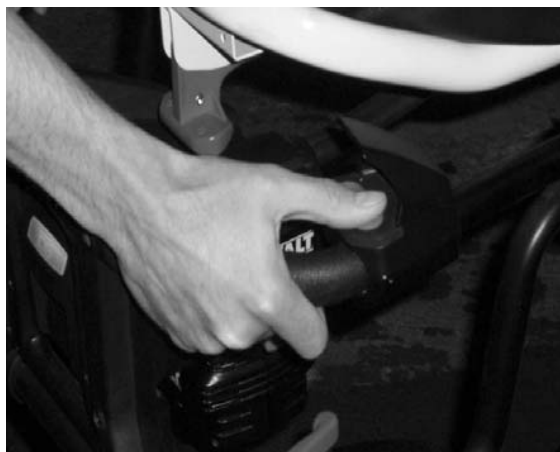
Figur 23: Tryck på utsträckningsknappen
