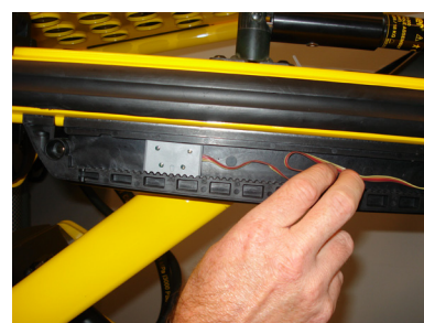
Rysunek 7: Mocowanie przewodów
