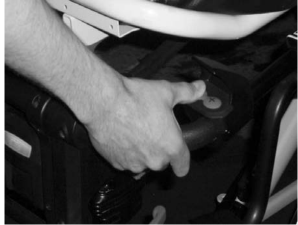
Afbeelding 21: Op de intrekknop drukken
