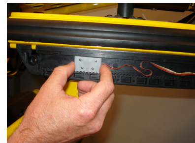
Figur 6: Justering af højde
