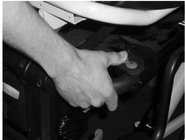
Obr. 21: Stisk tlačítka zasunutí
