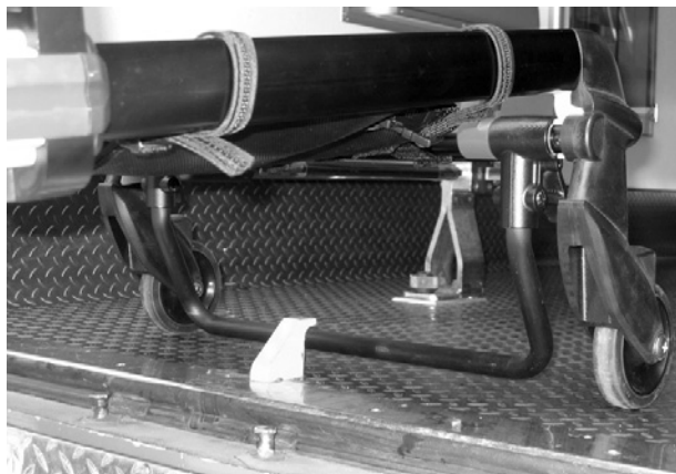
Rysunek 20: Pręt bezpieczeństwa załączony w haku bezpieczeństwa
