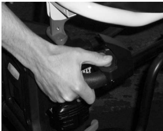
Rysunek 23: Naciśnięcie przycisku rozkładania
