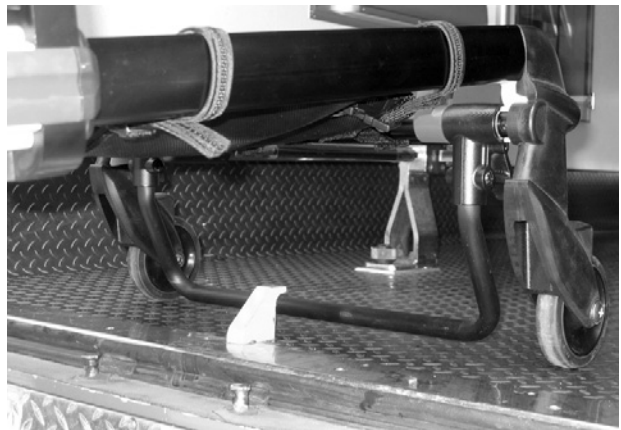
Abbildung 20: Sicherheitsbügel klinkt in Sicherheitshaken ein
