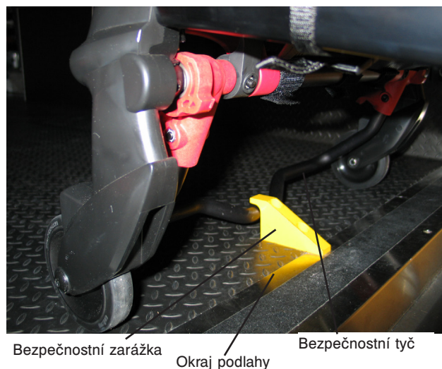
Obr. 17: Zachycení bezpečnostní tyče do bezpečnostní zarážky
