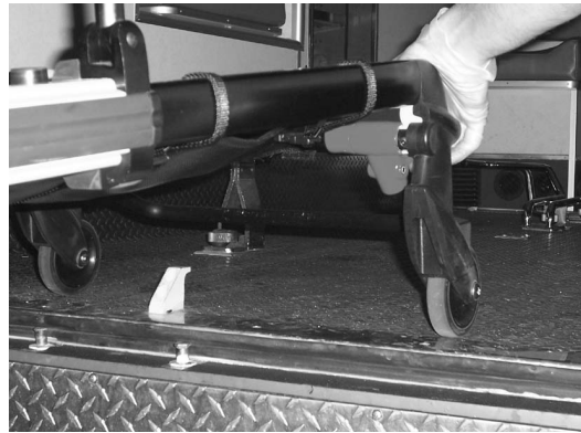
Figure 22 : Désengagement de la barre de sécurité
