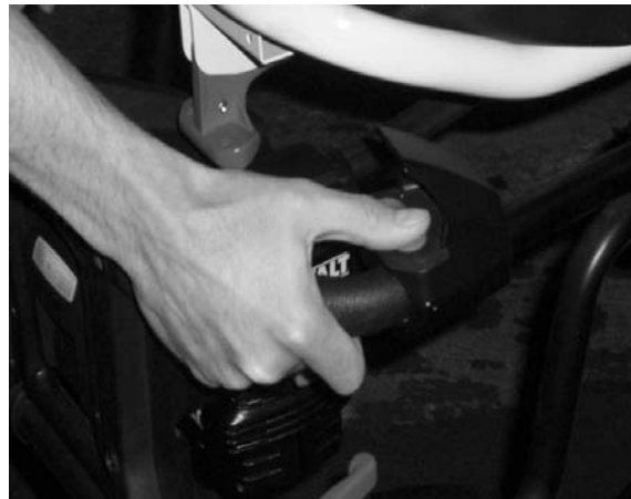
Obr. 23: Stisknutí tlačítka vysunutí
