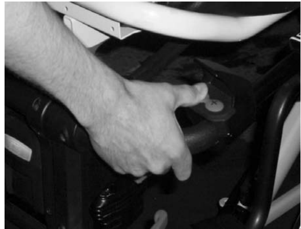
Rysunek 21: Naciśnięcie przycisku składania
