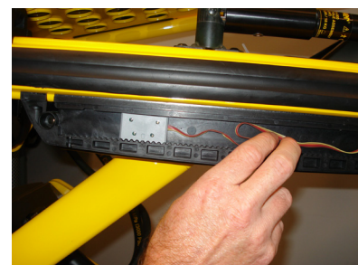
Abbildung 7: Sichern der Kabel
