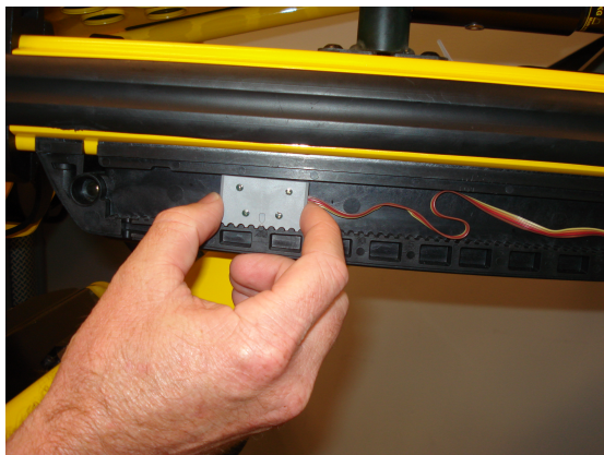
Рисунок 11 – Регулировка левого датчика высоты
