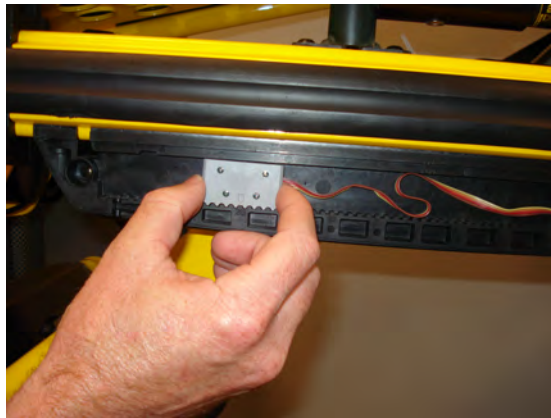
Figure 11 – Régler la hauteur du capteur gauche
