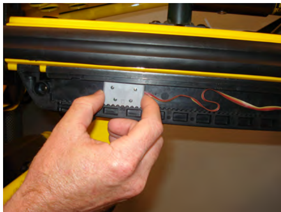
Рисунок 11 – Регулировка левого датчика высоты
