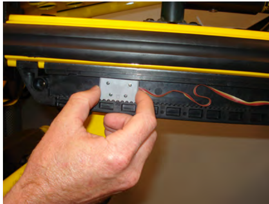
Figura 11 – Ajuste la altura del sensor izquierdo
