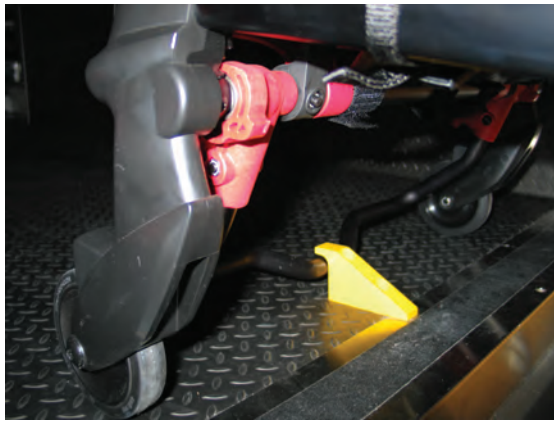
Рисунок 9 – Зацепление предохранительной штанги с предохранительным крюком автомобиля
