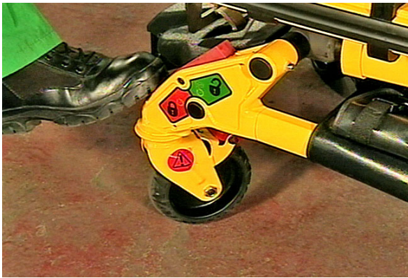
Kuva 32 – Pyörän ohjauslukon kytkeminen
