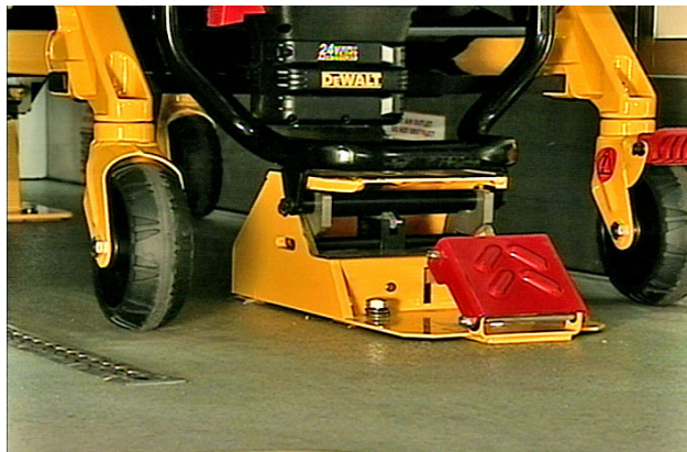
Figur 6 - Bårvagn i fästansordning (fotände)
