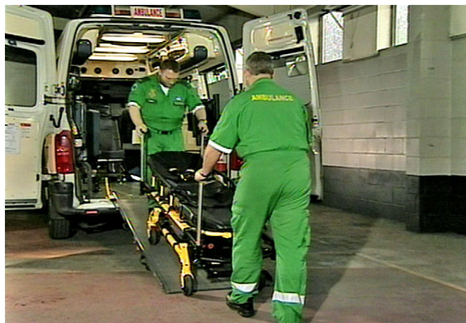
Abbildung 14 - Schieben der Trage in das Patientenabteil
