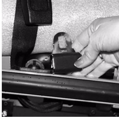
Figure 25 – Fixation des sangles de retenue sur une civière
