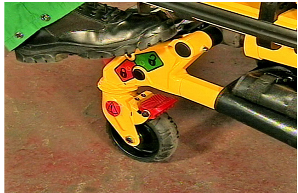
Afbeelding 33 - Stuurvergrendeling van de zwenkwieken uitschakelen
