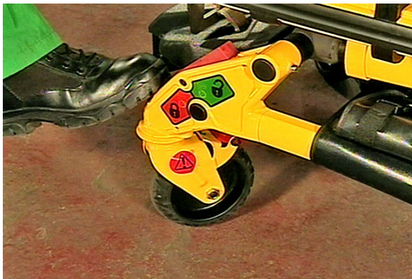
Figura 32 – Blocco ruote piroettanti inserito
