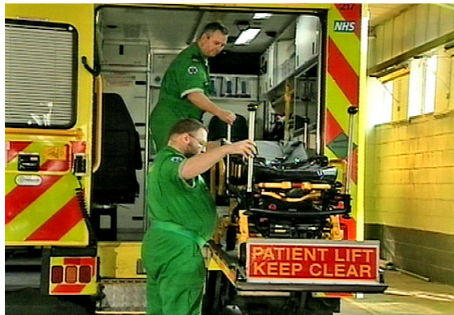
Abbildung 12 - Schieben der Trage in das Patientenabteil
