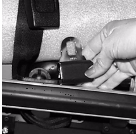
Figura 25 – Fissaggio delle cinghie di contenimento a una barella
