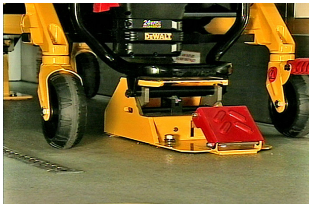
Figure 6 – Civière dans le dispositif de fixation (côté pieds)
