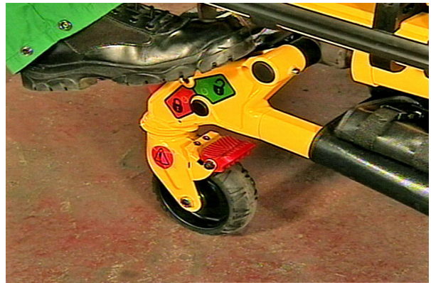
Kuva 33 – Pyörän ohjauslukon irrottaminen
