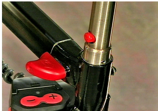
Figure 38 – Barre de poussée installée
