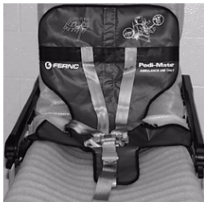
Figur 26 - Pedi-Mate® fastspændt til en bære
