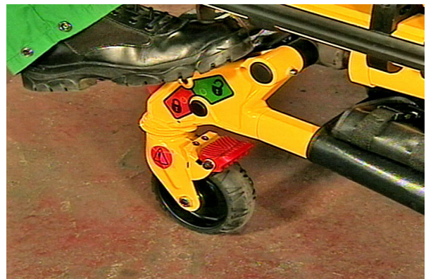
Figura 33 – Blocco ruote piroettanti disinserito
