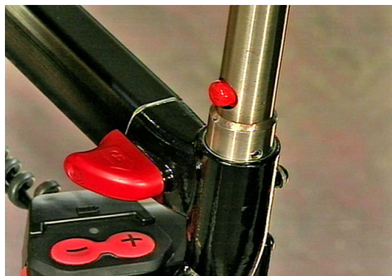
Figura 38 – Barra di spinta installata
