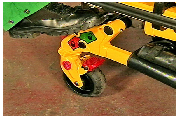
Figure 33 – Désengager le blocage des roulettes directrices
