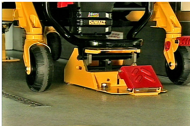
Abbildung 6 - Trage in Befestigung (Fußende)
