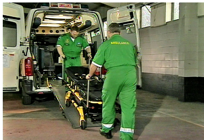
Kuva 14 – Työnnä ambulanssivuode potilasosastoon
