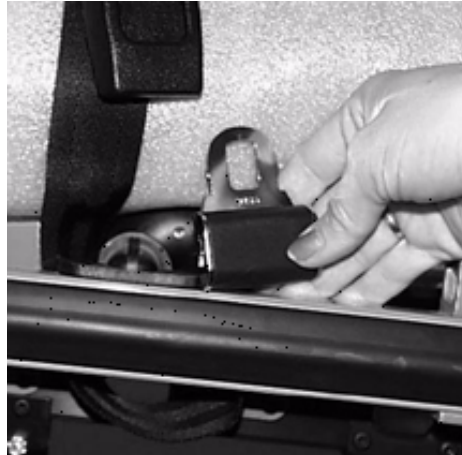
Afbeelding 25 - De veiligheidsriemen op een brancard beveiligen
