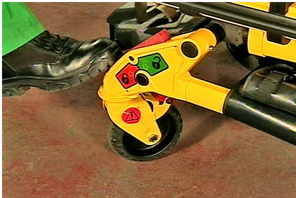
Afbeelding 32 - Stuurvergrendeling van de zwenkwieken inschakelen
