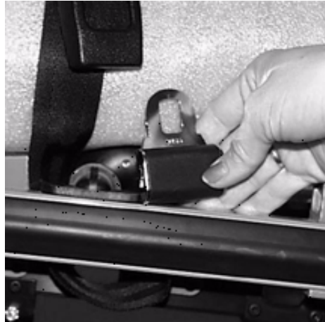
Abbildung 25 - Befestigen der Sicherheitsgurte an einer Trage
