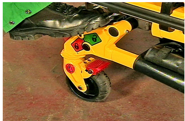
Abbildung 33 - Lösen der Rollenlenkungsarretierung
