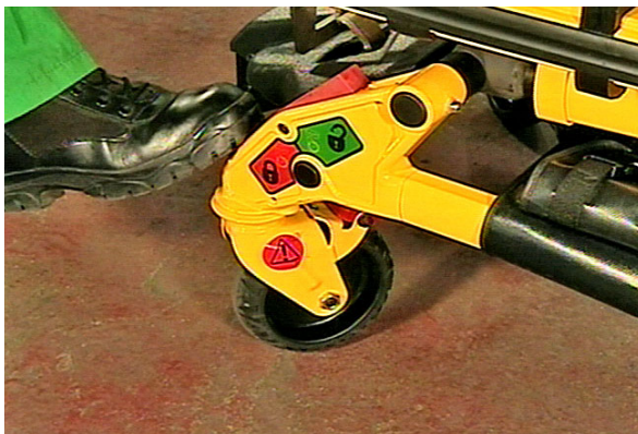
Figur 32 - Koppla in styrehjulslåset
