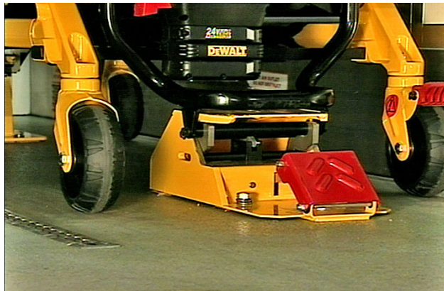
Kuva 6 – Ambulanssivuode kiinnittimessä (jalkopää)
