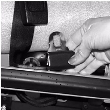
Kuva 25 – Turvakiinnittimien kiinnittäminen ambulanssivuoteeseen
