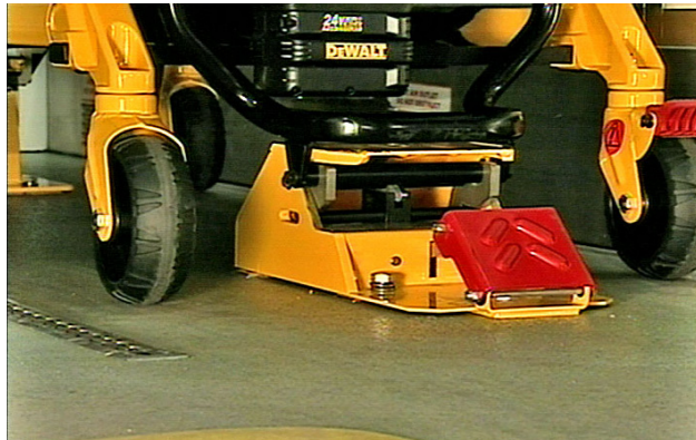
Figura 6 – Barella nel dispositivo di ancoraggio – lato piedi
