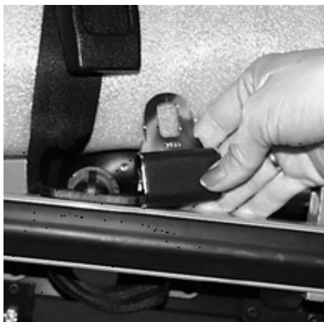
Figur 25 - Fastsättning av säkerhetsbältena på en bårvagn
