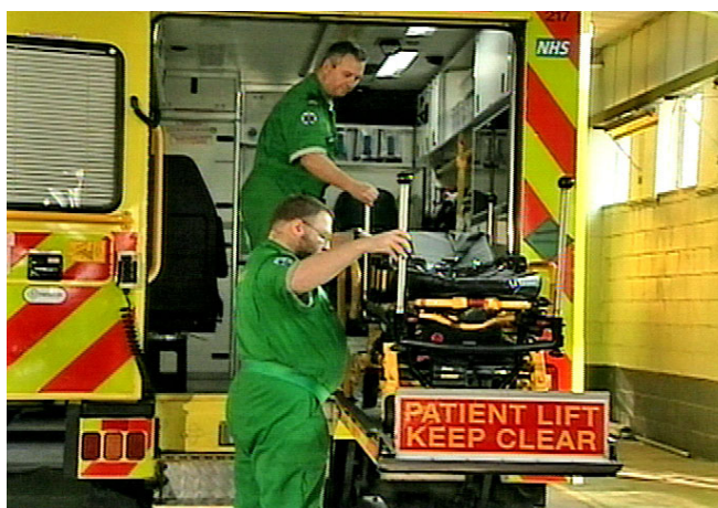
Kuva 12 – Työnnä ambulanssivuode potilasosastoon
