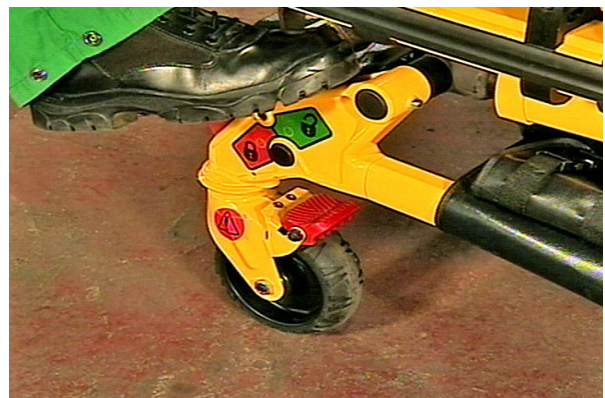
Figur 33 - Koppla loss styrehjulslåset
