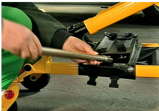
Figure 39 – Stockage de la barre de poussée
