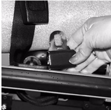
Figura 32.3 – Fissaggio delle cinghie di contenimento alla barella
