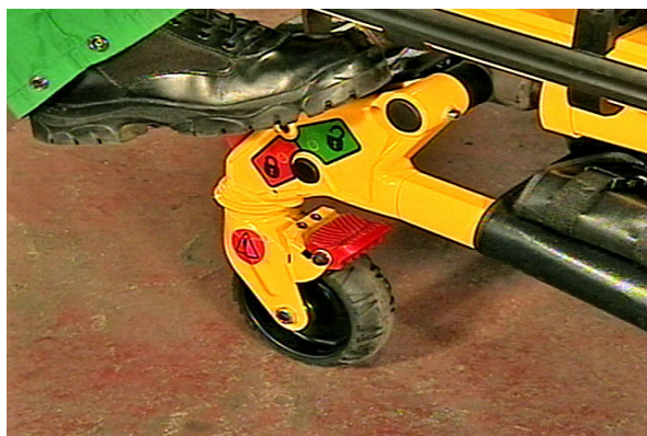
Afbeelding 27.2: Stuurvergrendeling van de zwenkwielen uitschakelen
