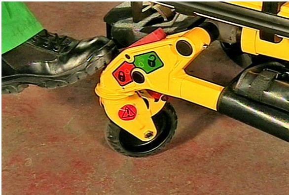
Figur 27.1: Koppla in styrehjulslåset
