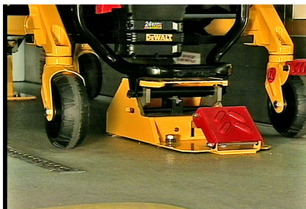
Abbildung 6: Trage in Befestigung (Fußende)
