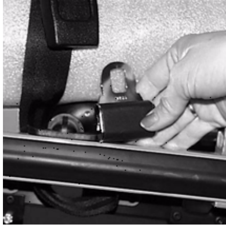
Kuva 32.3: Turvakiinnittimien kiinnittäminen ambulanssivuoteeseen
