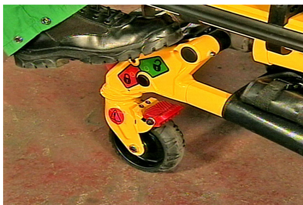
Abbildung 27.2: Lösen der Rollenlenkungsarretierung
