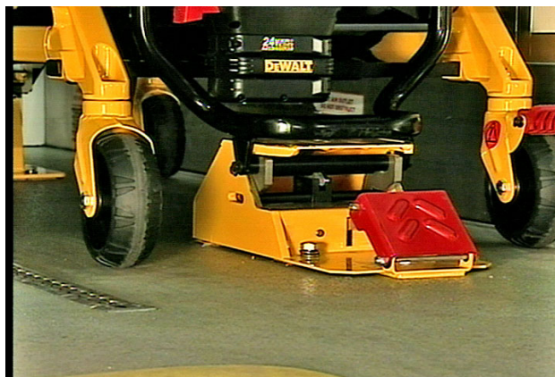
Kuva 6: Ambulanssivuode kiinnittimessä (jalkopää)
