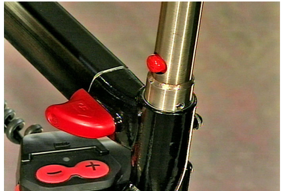
Figure 28.1 : Barre de poussée installée
