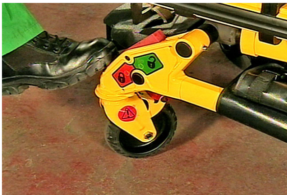
Figure 27.1 : Engager le blocage des roulettes directrices
