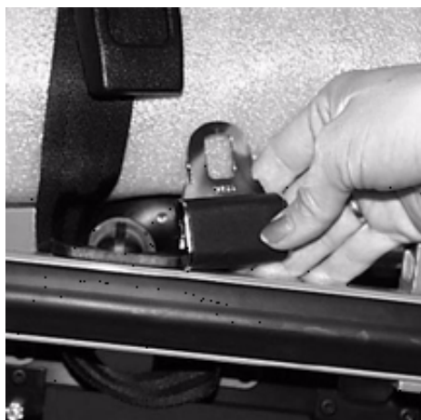
Figur 32.3: Fastgørelse af sikkerhedssele på en bære
