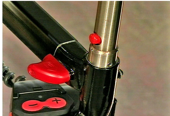
Figura 28.1 – Barra di spinta installata
