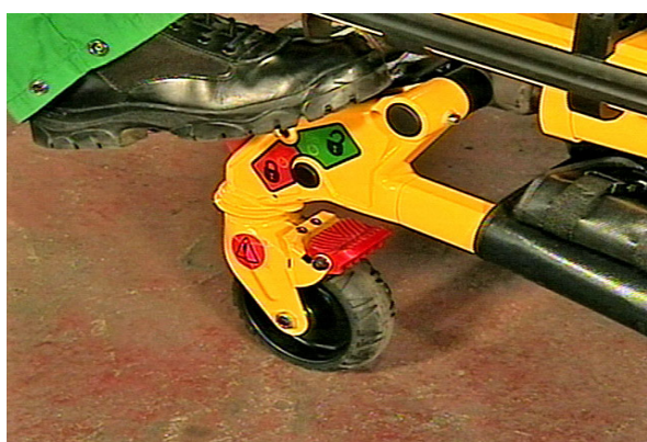
Figura 27.2 – Blocco ruote piroettanti disinserito
