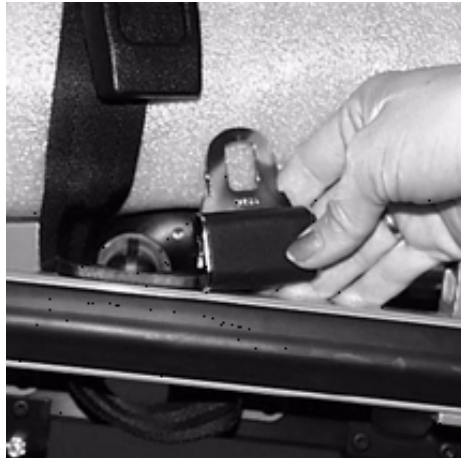
Figure 32.3 : Fixation des sangles de retenue sur une civière
