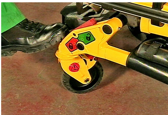
Kuva 27.1: Pyörän ohjauslukon kytkeminen
