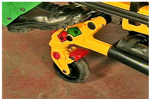
Figure 27.2 : Désengager le blocage des roulettes directrices
