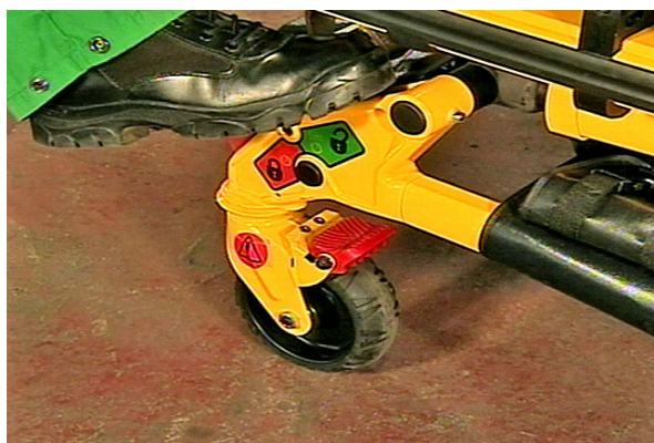
Kuva 27.2: Pyörän ohjauslukon irrottaminen
