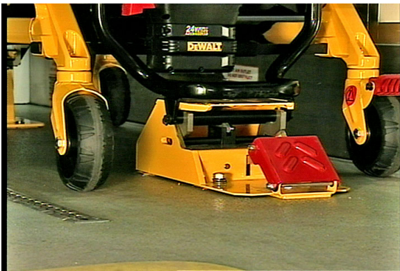
Figura 8 – Barella sia nel lato testa sia nel lato piedi del dispositivo di ancoraggio
