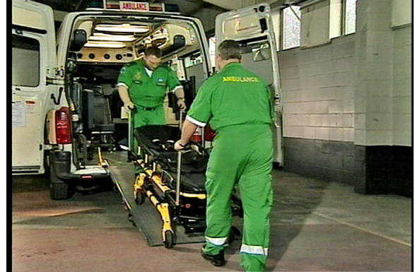
Figure 14 – Centrer la civière sur la rampe tout en la dirigeant vers le haut.
