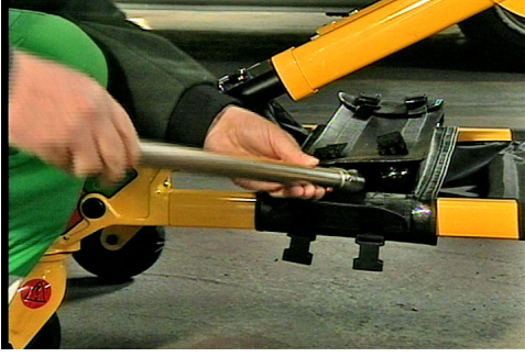
Şekil 38 – İtme çubuklarının çıkarılması
