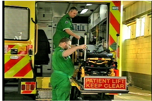
Figure 12 – Les deux opérateurs doivent guider la civière pour l'amener dans le compartiment patient du véhicule
