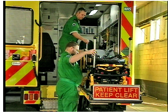
Figura 12 – La barella viene introdotta nella cabina paziente del veicolo da entrambi i barellieri
