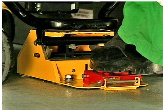
Slika 10 – Pritisnite nožnu papučicu
