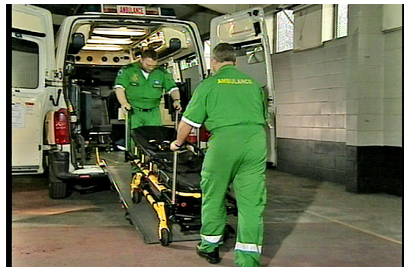
Afbeelding 14 – Geleid de brancard over het midden van de helling
