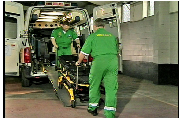
Kuva 14 – Ohjaa parit luiskan keskiosaa pitkin ylös
