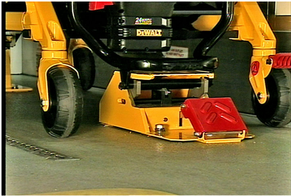
Figur 8 – Båre i både hovedenden og fodenden af bærebeslaget
