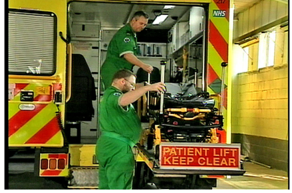
Şekil 12 – Her iki operatör de karyolayı araç hasta bölümüne yönlendirmelidir
