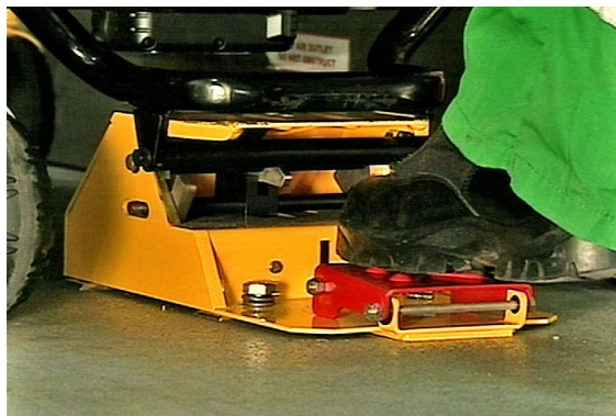
Figura 10 – Premere il pedale
