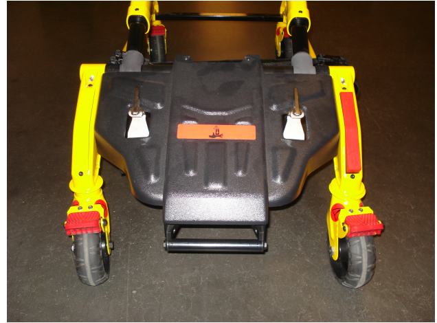
Figura 39 – Agganciare la barra di sollevamento all'apposita borsa
