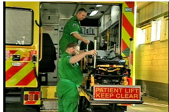
Afbeelding 12 – Beide bedieners geleiden de brancard de patiëntruimte van het voertuig in
