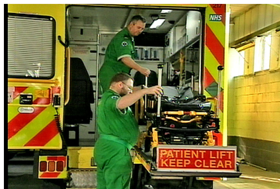
Slika 12 – Oba rukovaoca uvode krevet u odjeljak za pacijenta u vozilu
