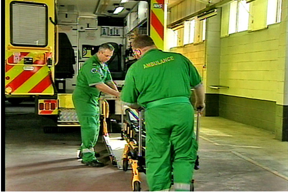
Şekil 11 – Arka kapak yük platformundaki karyola
