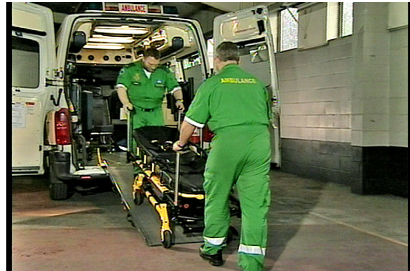
Slika 14 – Nosila vodite navzgor po sredini klančine
