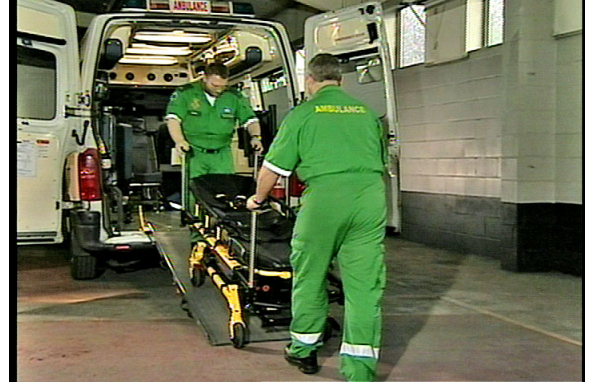
řekil 14 – Karyolayı rampanın merkezine ynlendirin
