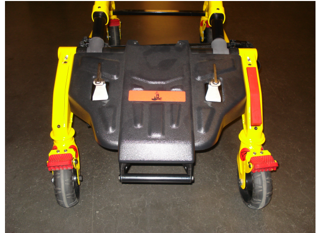
Slika 39 – Pritrditev vreče za shranjevanje potisnih drogov
