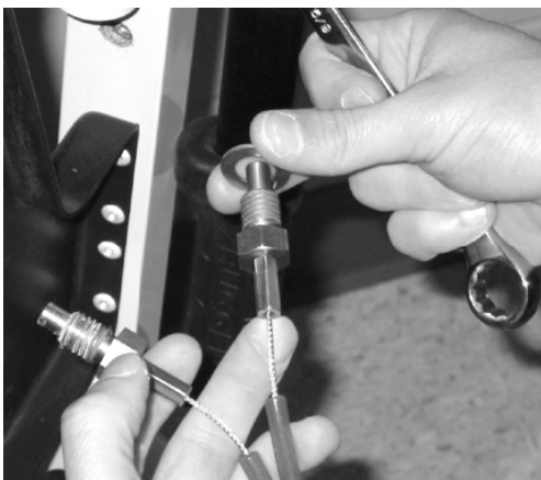
Abbildung 66 - Die Unterlegscheibe auf den neuen Seilzug schieben
