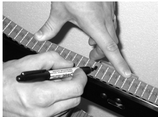
Figure 57 - Marquer une dent de chenille aux fins de référence
