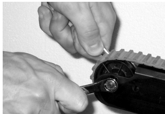
Abbildung 60 - Riemen mit Schraubenschlüsseln spannen
