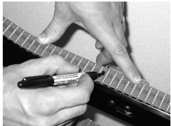
Abbildung 57 - Einen Riemenzahn zu Referenzzwecken markieren
