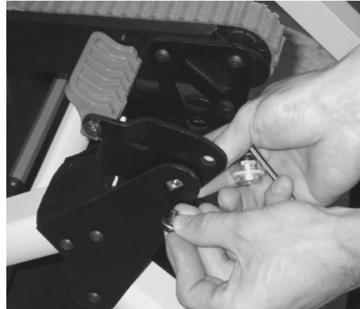
Abbildung 49 - Die Zapfen des Schienenabstandhalters abnehmen
