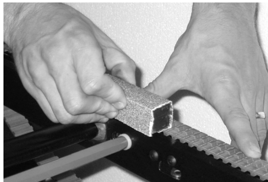
Εικόνα 58 - Εκτριψτε τις επιφάνειες φθοράς
