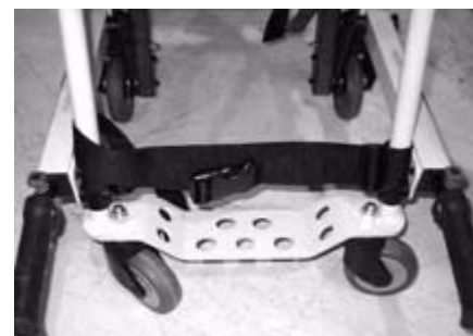
Rysunek 10-18 - Przymocowywanie pasa nożnego
