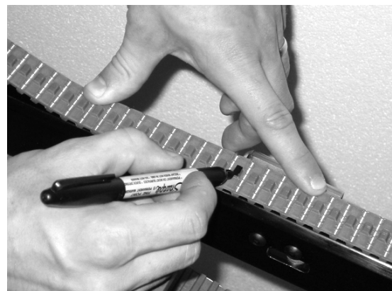
Figura 57 - Marcatura di un dente del cingolo come riferimento
