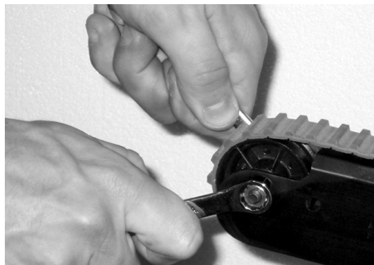
Εικόνα 60 - Χρησιμοποιήστε κλειδιά για την εφαρμογή τάσης στην ερπύστρια
