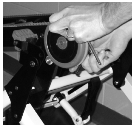
Figura 48 - Retire o conjunto da roda
