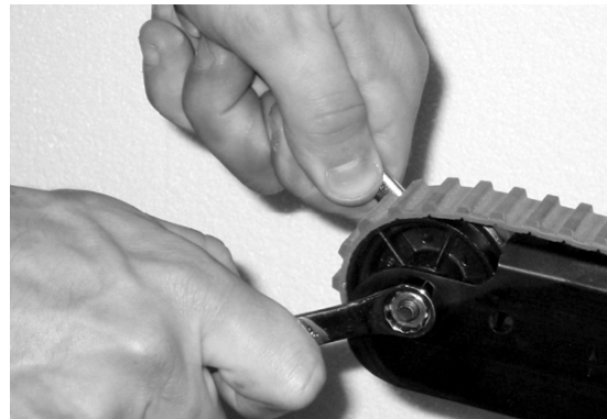
Figur 53 - Brug skruenøgler til at spænde bælteerne
