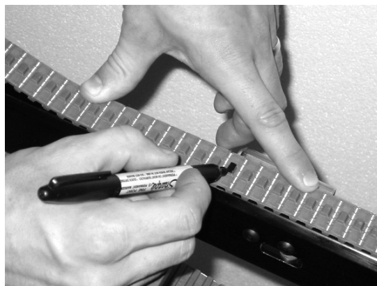
Figur 57 - Markér en tand på bæltet som reference
