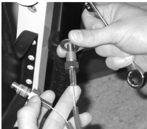
Figur 66 - Sätt brickan på den nya kabeln
