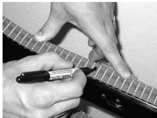
Figura 57 - Marque um dente da correia para sua referência
