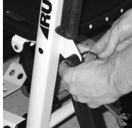
Εικόνα 46 - Αφαιρέστε τον κοχλία, τη βίδα και τη ροδέλα
