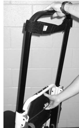
Figura 64 - Allungamento del maniglione telescopico
