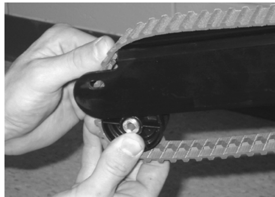
Abbildung 50 - Die Rollen abnehmen
