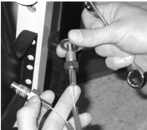
Figure 66 - Placer la rondelle sur le nouveau câble
