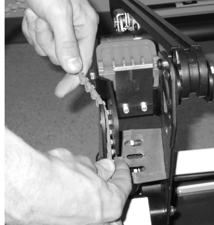
Figura 52 - Prenda a nova correia dentada
