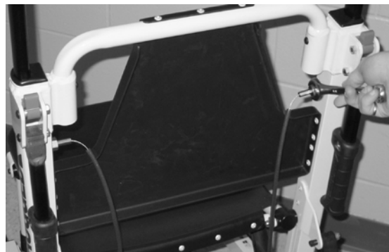
Εικόνα 67 - Προσαρτήστε τη μία πλευρά του νέου καλωδίου
