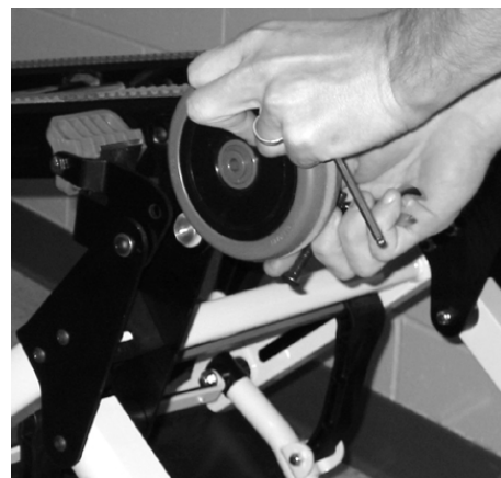
Figura 48 - Rimozione del gruppo della ruota
