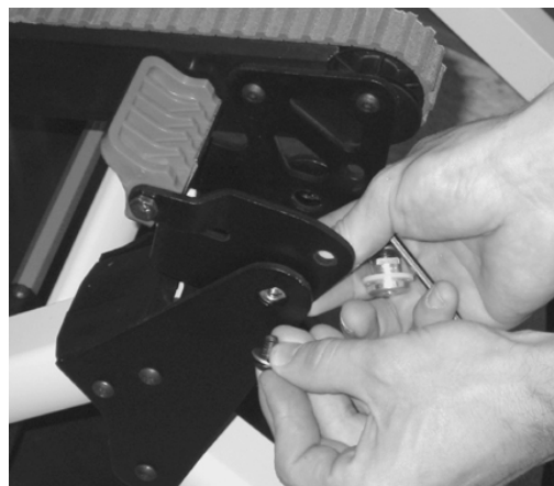
Rysunek 49 - Wyjąć osie przegubu rozpórek gaśienicy
