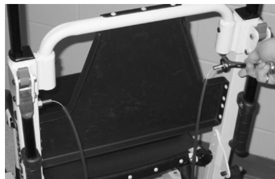
Figur 67 - Fäst ena sidan av den nya kabeln
