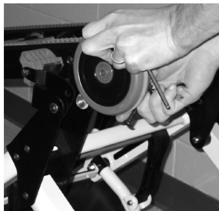
Figuur 63 - Het wielsamenstel verwijderen
