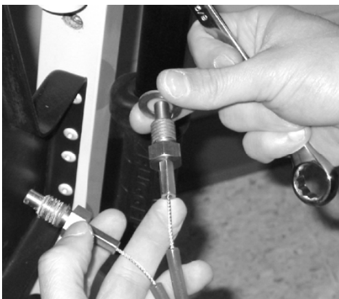
Figura 66 - Posizionamento della rondella sul nuovo cavo
