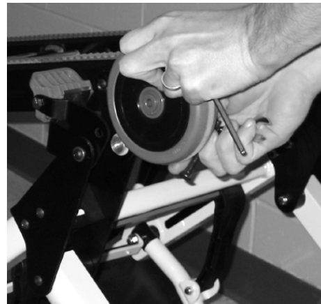
Abbildung 63 - Die Radbaugruppe abnehmen
