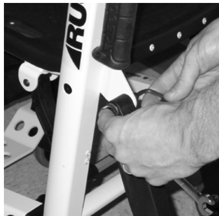
Kuva 46 - Irrota ruuvi, mutteri ja aluslevy
