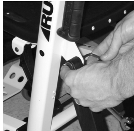
Rysunek 46 - Wyjąć śrubę, nakrętkę i podkładkę
