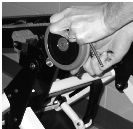
Εικόνα 63 - Αφαιρέστε τη διάταξη των τροχών
