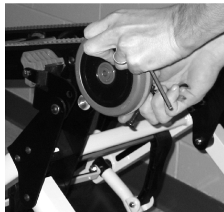
Figure 48 - Retirer l'ensemble de roues
