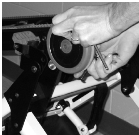
Figura 63 - Retire el conjunto de ruedas
