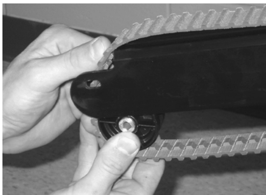
Figuur 50 - De rollen verwijderen
