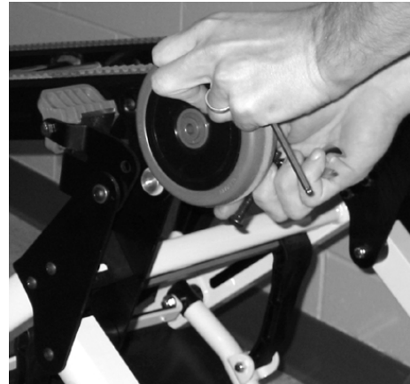
Figura 63 - Retire o conjunto da roda
