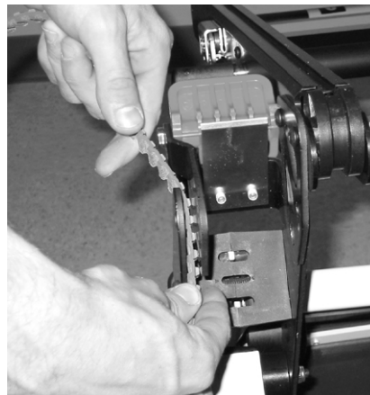
Kuva 52 - Kiinnitä uusi telaketjun hihna
