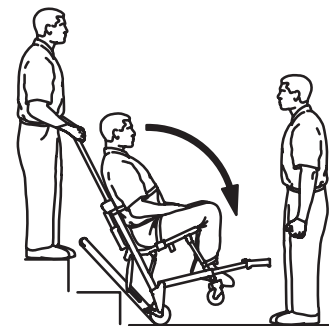
Figure 32 - Bas de l'escalier
