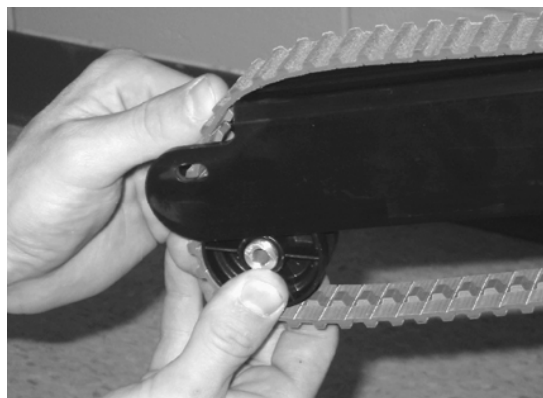
Εικόνα 50 - Αφαιρέστε τους κυλίνδρους
