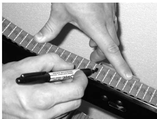
Rysunek 57 - Zaznaczyć ząb na pasku jako punkt odniesienia
