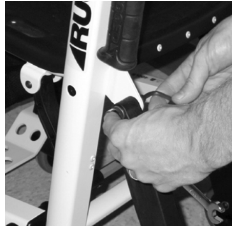
Figura 46 - Retire o parafuso, a porca e a anilha
