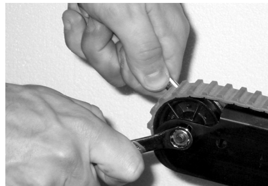
Figure 53 - Tendre les chenilles avec des clés
