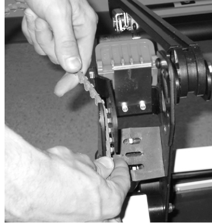
Figuur 52 - De nieuwe rupsband aanbrenge
