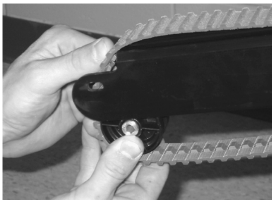
Figure 50 - Retirer les rouleaux
