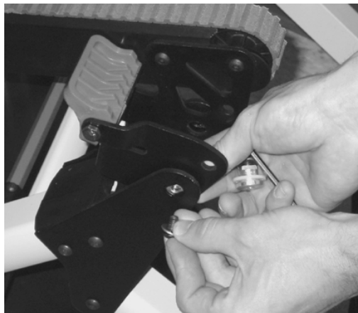
Figure 49 - Retirer les pivots de la pièce d'espacement de chenilles
