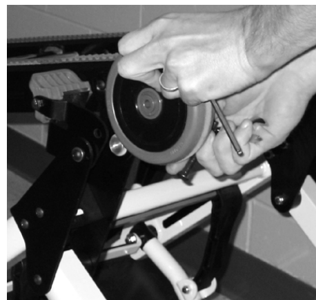
Figur 48 - Ta bort hjulenheten
