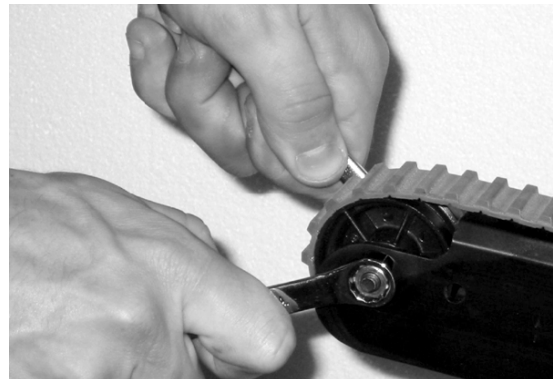
Figur 60 - Brug skruenøgler til at påføre spænding til bæltet
