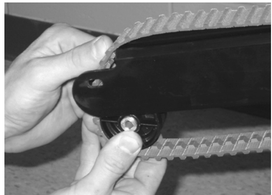
Figura 50 - Retire los rodillos
