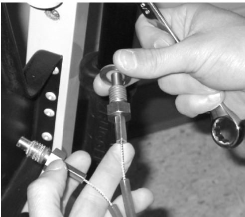
Εικόνα 66 - Τοποθετήστε τη ροδέλα στο νέο καλώδιο
