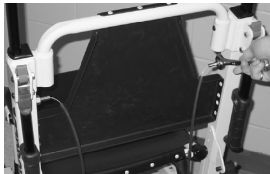
Abbildung 67 - Eine Seite des neuen Seilzugs befestigen
