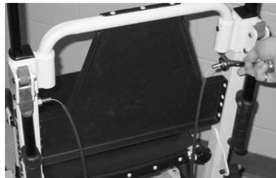
Figura 67 - Fije un extremo del cable nuevo
