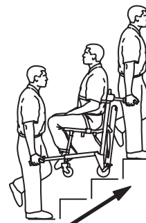
Abbildung 35 - Eine Treppe hinauf transportieren
