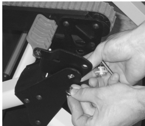
Εικόνα 49 - Αφαιρέστε τους πείρους περιστροφής του διαχωριστικού των ραγών
