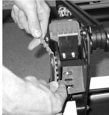
Figur 52 - Montér det nye larvebælte
