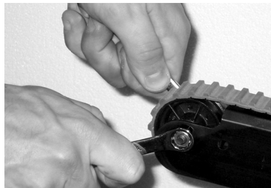
Figur 53 - Använd nycklar för att dra åt banden
