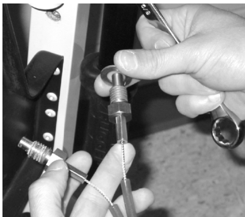
Figura 66 - Coloque a anilha no cabo novo
