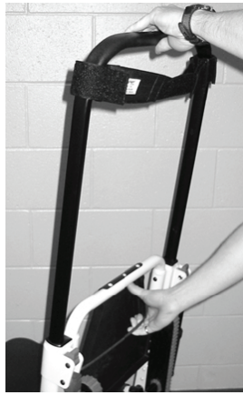
Figure 23 – Élever la poignée de commande supérieure extensible
