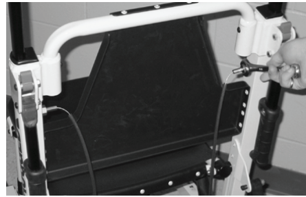
Figure 26 – Fixer un côté du nouveau câble
