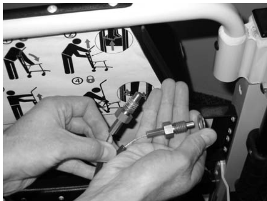
Figura 51 - Coloque a anilha no cabo novo
