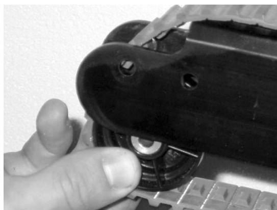
Figur 43 - Ta bort hjulets distansbricka nedåt mot golvet
