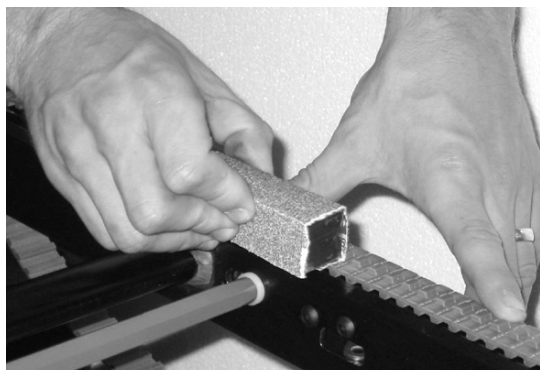
Rysunek 45 - Wygładzić zużywane powierzchnie papierem ściernym
