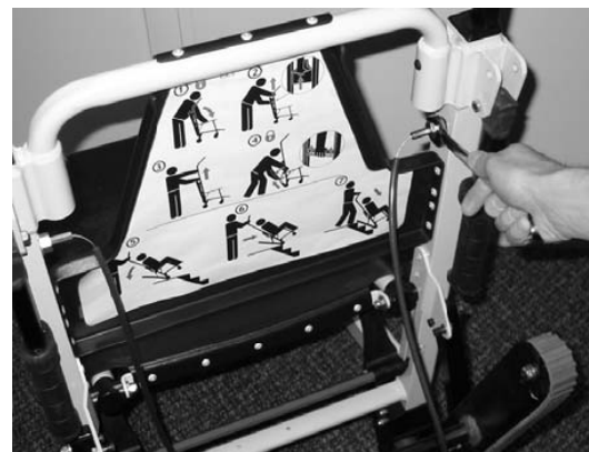
Figura 52 - Fije un extremo del cable nuevo
