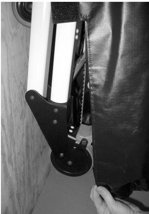
Abbildung 40 - Die untere Tasche der Abdeckung über die Räder ziehen
