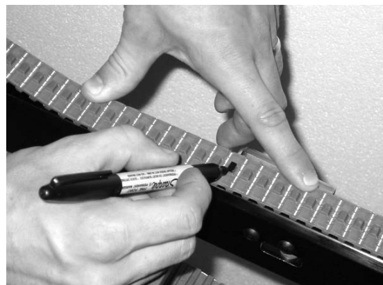
Figura 44 - Marque um dente da correia para sua referência
