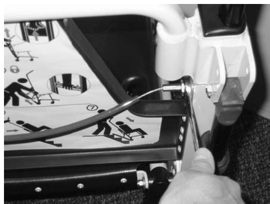
Figura 50 - Rimozione di un lato del cavo
