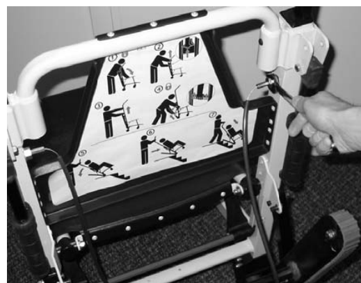
Figura 52 - Collegamento di un'estremità del nuovo cavo
