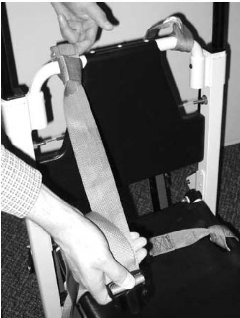
Rysunek 5 - Zaciągnąć pas
