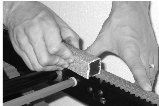
Figura 45 - Lixe as superfícies desgastadas
