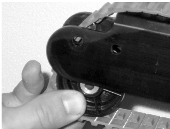
Figuur 43 - Het wiel en het afstandstuk in de richting van de vloer verwijderen
