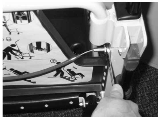
Figur 50 - Fjern en side af kablet
