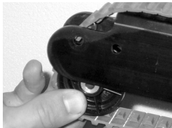
Figura 43 - Retire a roda do separador na direcção do chão
