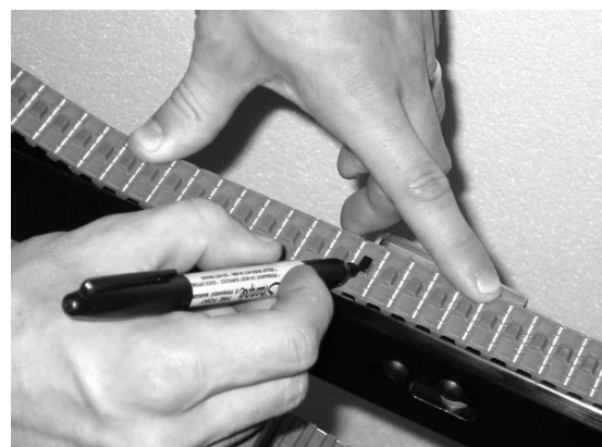
Figura 44 - Marcatura di un dente del cingolo come riferimento
