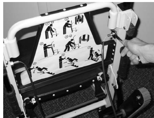
Figur 52 - Montér den ene side af det nye kabel
