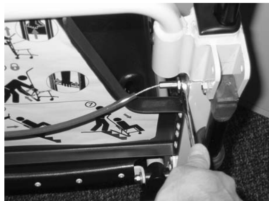
Abbildung 50 - Eine Seite des Kabels entfernen
