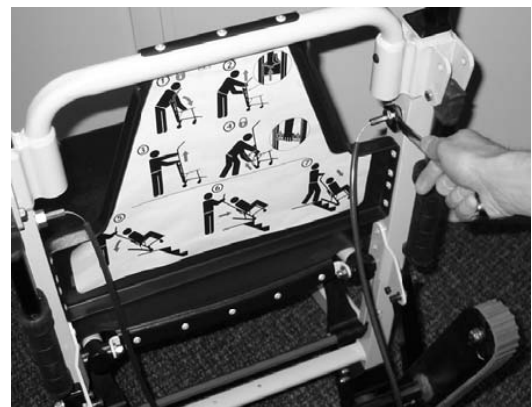
Kuva 52 - Kiinnitä uusi vaijeri toiselta puolelta
