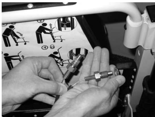
Figur 51 - Sätt brickan på den nya kabeln
