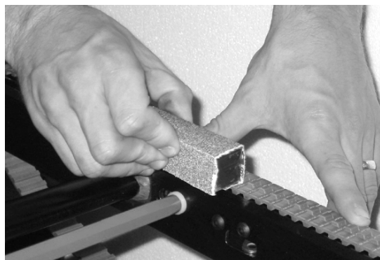
Figure 45 - Poncer les surfaces d'usure
