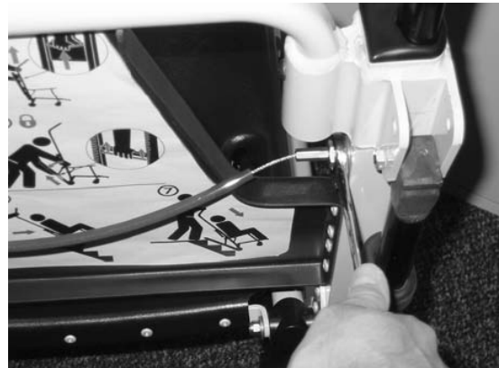
Εικόνα 50 - Αφαιρέστε τη μία πλευρά του καλωδίου
