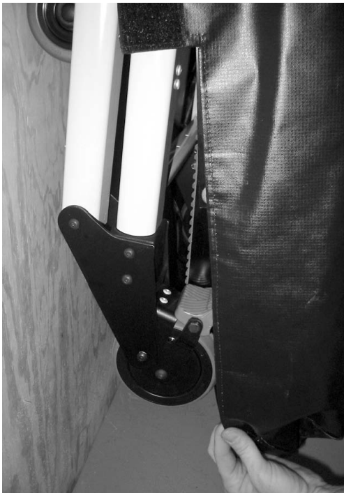
Figura 40 - Infilare la tasca inferiore sulle ruote
