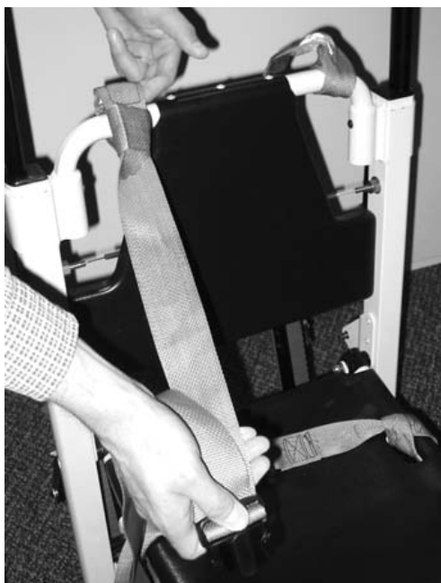
Figuur 5 - De riem strak trekken
