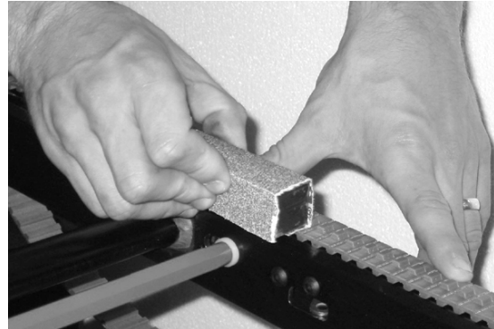
Figura 45 - Lije las superficies de desgaste
