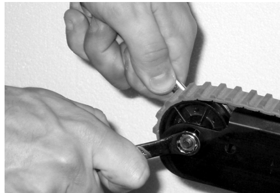
Εικόνα 47 - Χρησιμοποιήστε κλειδιά για την εφαρμογή τάσης στην ερπύστρια
