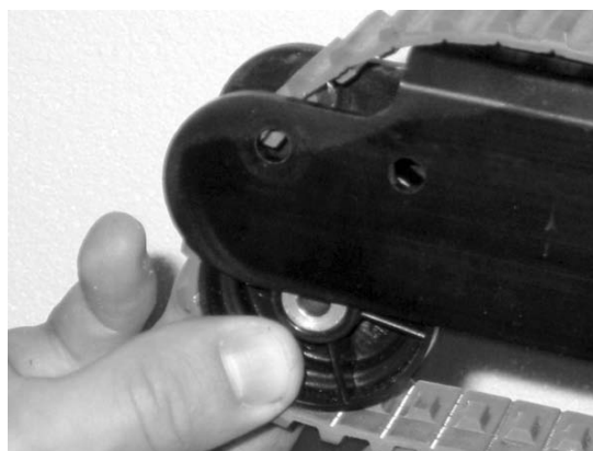
Rysunek 43 - Wyjąć koło i rozpórkę w kierunku podłogi
