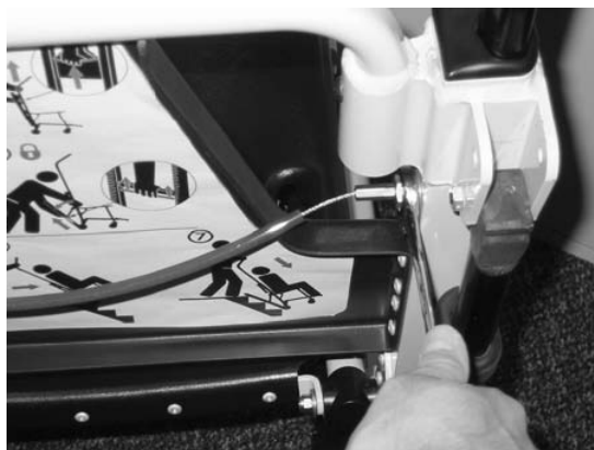
Figuur 50 - Eén kant van de kabel verwijderen
