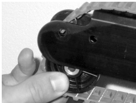
Figura 43 - Quite la rueda y el portaboquilla en la dirección del suelo
