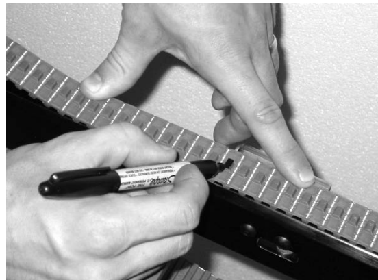
Abbildung 44 - Einen Riemenzahn zu Referenzzwecken markieren
