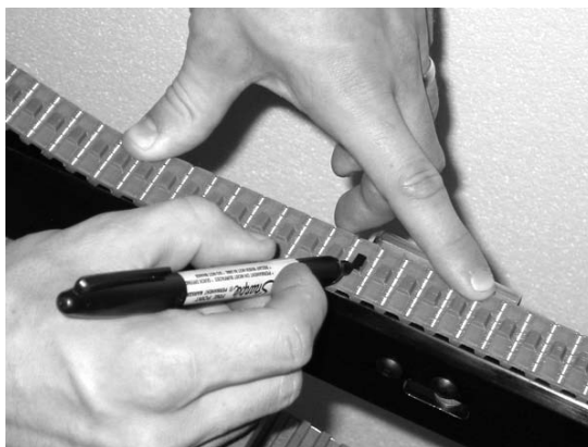
Εικόνα 44 - Σημειώστε μια οδόντωση στην ερπύστρια ως σημείο αναφοράς
