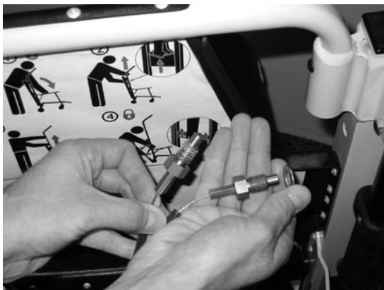
Figura 51 - Posizionamento della rondella sul nuovo cavo
