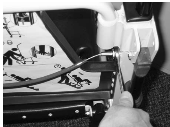
Figur 50 - Fjern en side af kablet
