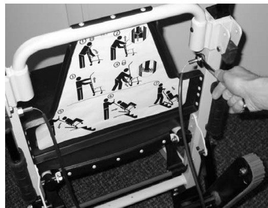
Figuur 52 - Eén kant van de nieuwe kabel aanbrengen
