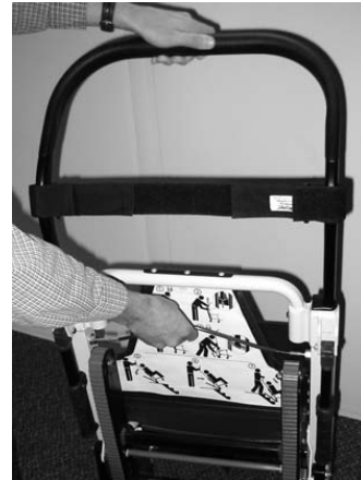
Figur 49 - Hæv det udtrækkelige håndtag
