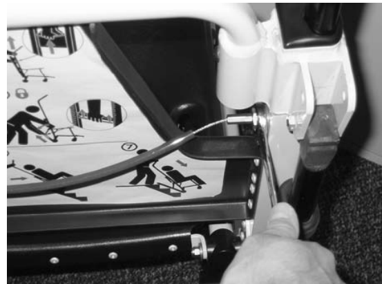
Figur 50 - Ta bort ena sidan av kabeln
