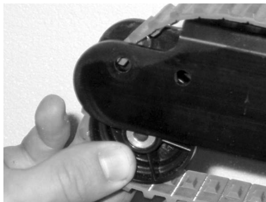
Figure 43 - Retirer la roue et la pièce d'espacement vers le bas en direction du sol
