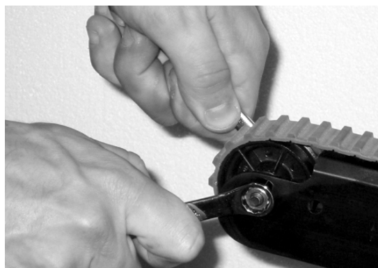
Figura 47 - Uso delle chiavi per mettere in tensione il cingolo
