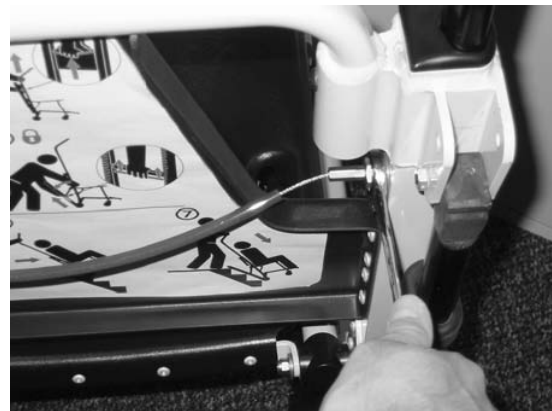
Figuur 50 - Eén kant van de kabel verwijderen
