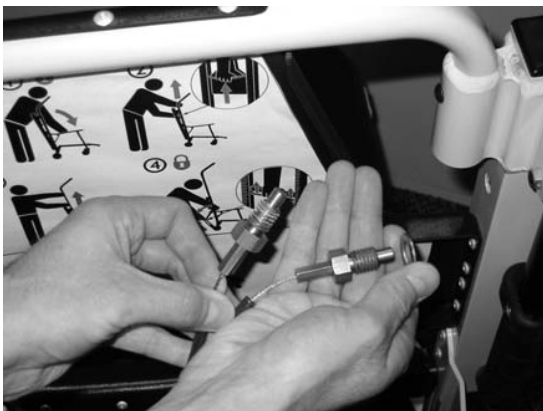
Figure 51 - Placer la rondelle sur le nouveau câble
