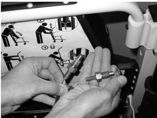
Rysunek 51 - Umieścić podkładkę na nowym przewodzie
