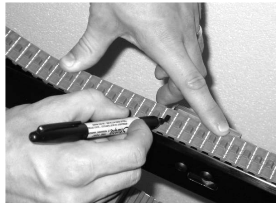
Figur 44 - Markér en tand på bæltet som reference
