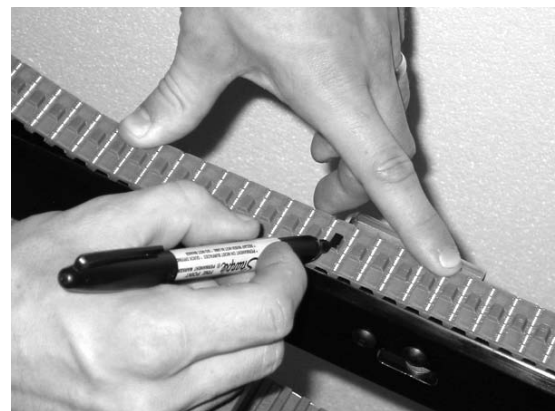
Rysunek 44 - Zaznaczyć ząb na pasku jako punkt odniesienia
