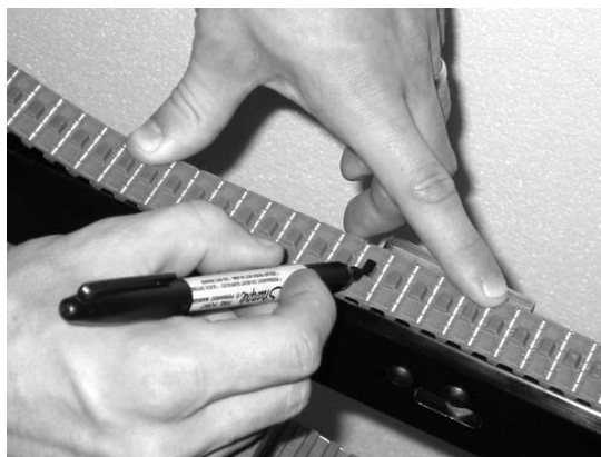
Figura 44 - Marque um dente da correia para sua referência
