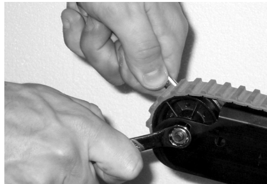
Figura 47 - Utilize as chaves inglesas para aplicar tensão na correia
