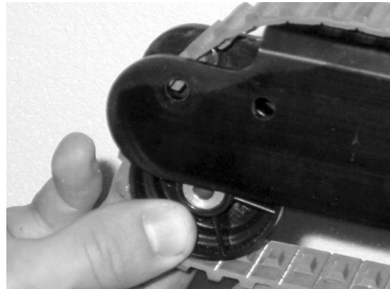
Figur 43 - Ta bort hjulets distansbricka nedåt mot golvet
