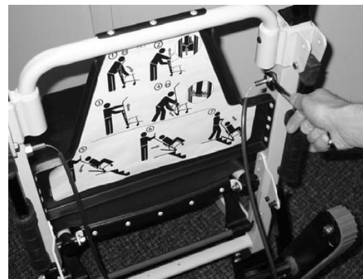
Figure 52 - Fixer un côté du nouveau câble
