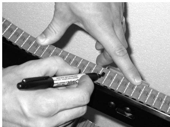
Abbildung 44 - Einen Riemenzahn zu Referenzzwecken markieren
