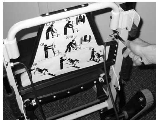
Figur 52 - Fäst ena sidan av den nya kabeln
