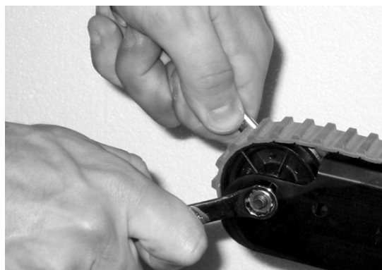
Figure 47 - Utiliser les clés pour tendre la chenille
