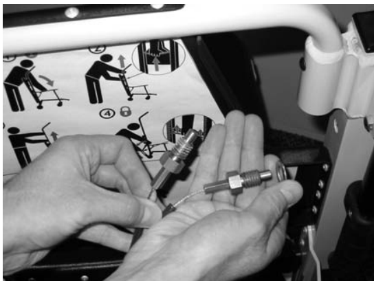
Figur 51 - Sæt skiven på det nye kabel
