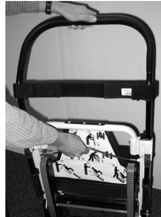
Rysunek 49 - Unieść wysuwalną rączkę
