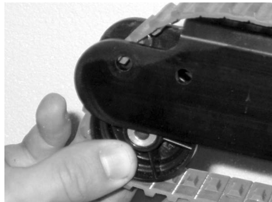
Figura 43 - Rimozione del distanziatore della ruota in direzione del pavimento
