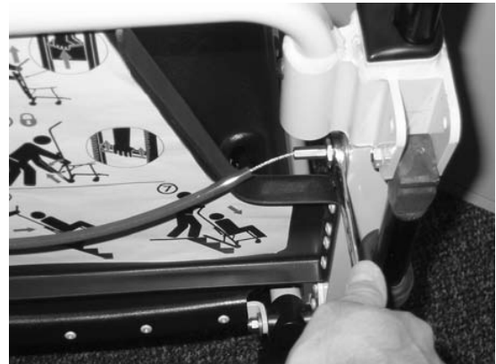
Εικόνα 50 - Αφαιρέστε τη μία πλευρά του καλωδίου
