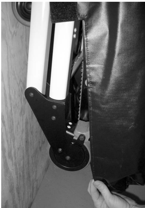
Figure 39 - Glisser la poche inférieure sur les roues
