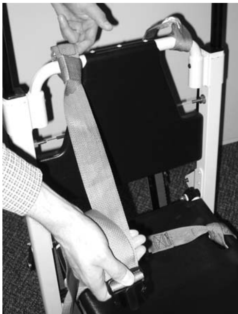
Εικόνα 5 - Τραβήξτε έως ότου τεντωθεί ο ιμάντας
