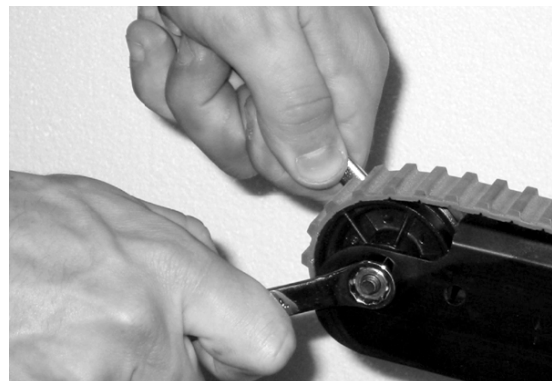
Abbildung 47 - Riemen mit Schraubenschlüsseln spannen
