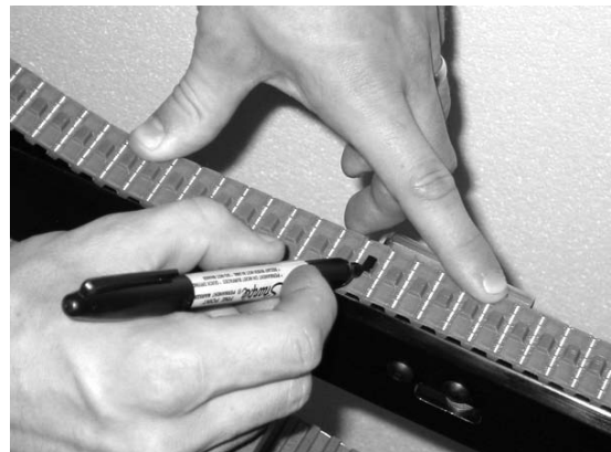
Εικόνα 44 - Σημειώστε μια οδόντωση στην ερπύστρια ως σημείο αναφοράς
