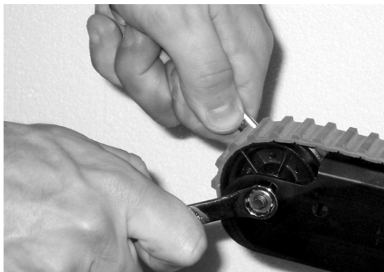
Figura 47 - Utilice llaves para aplicar tensión a la guía
