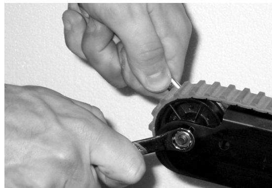
Figuur 47 - Moersleutels gebruiken om de band onder spanning te zetten
