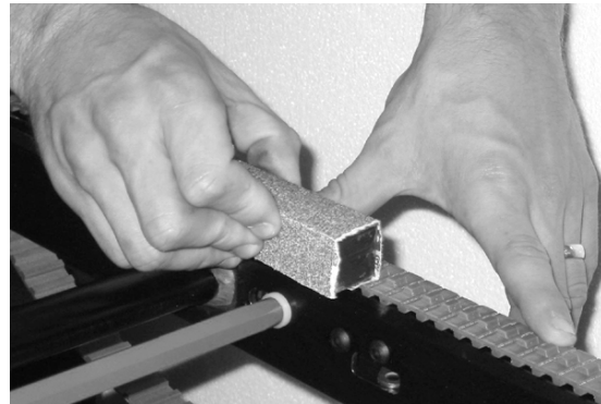
Figura 45 - Lixe as superfícies desgastadas
