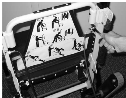
Εικόνα 52 - Προσαρτήστε τη μία πλευρά του νέου καλωδίου
