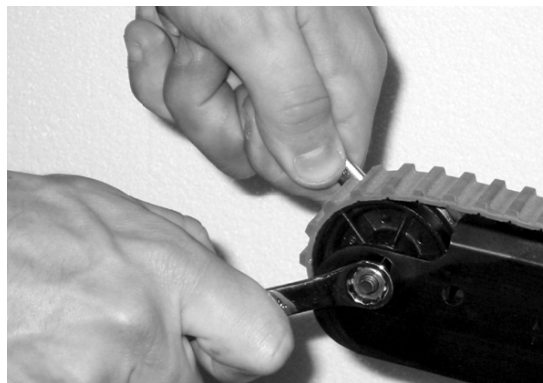
Figur 47 - Brug skruenøgler til at påføre spænding til bæltest
