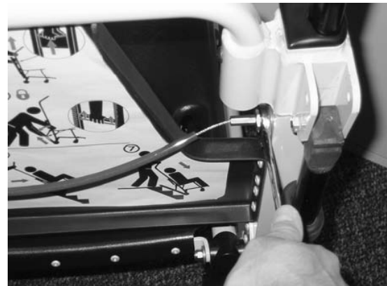
Figura 50 - Rimozione di un lato del cavo
