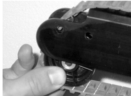
Kuva 43 - Irrota pyörän välikappale alaspäin lattian suuntaan
