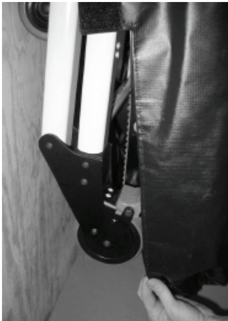
Figura 23 – Superponer el bolsillo inferior sobre las ruedas
