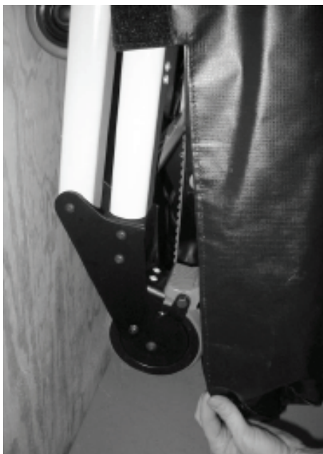
Σχήμα 23 – Περάστε τον κάτω θύλακα πάνω από τους τροχούς
