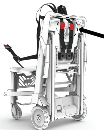
รูปที่ 26 – ยกลูกบิดยาว PCS เพื่อปรับเข็มขัดรัดไหล่ให้แน่นหรือคลายออก
