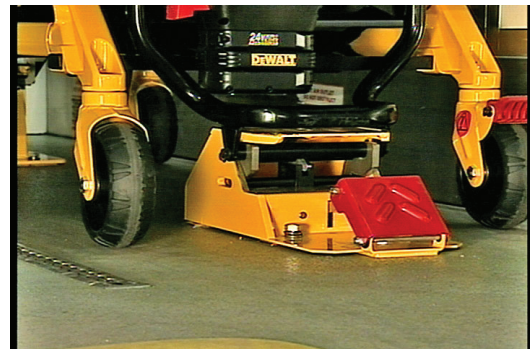
Abbildung 13 – Trage in Befestigung (Fußende)
