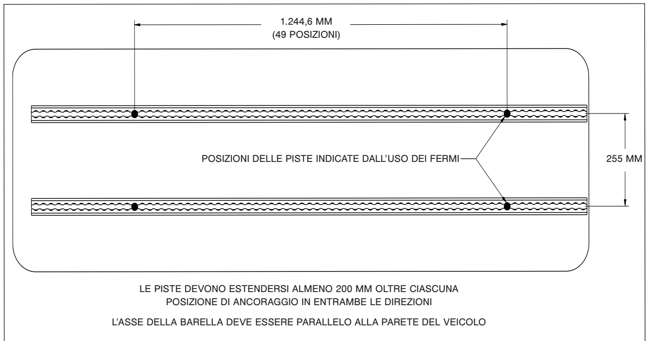
Figura 12 – Posizioni di installazione delle piste a pavimento
