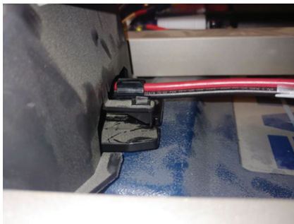
Figura 8 – Împingeți conectorul în cavitate
