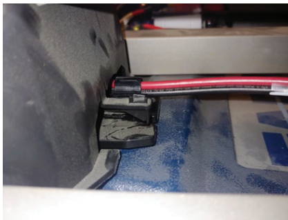
Ábra 8 – Nyomja be a csatlakozót a mélyedésbe.
