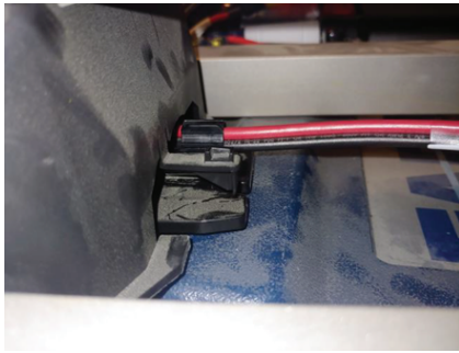
Figura 8 – Empurre o conector para a cavidade
