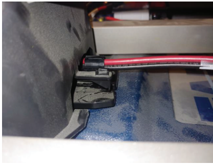
Figura 8 – Connettore inserito nella cavità
