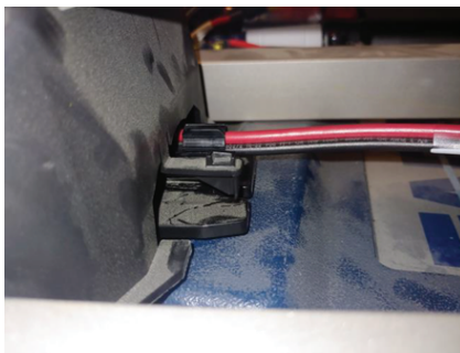
Figur 8 – Skyv kontakten inn i hulrommet.
