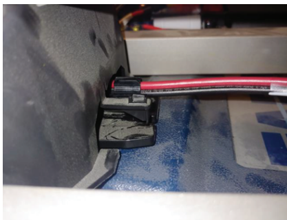
Slika 8 – Priključek potisnite v odprtino.
