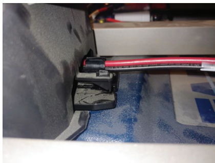
Obrázok 8 – Zasunutie konektora do dutiny
