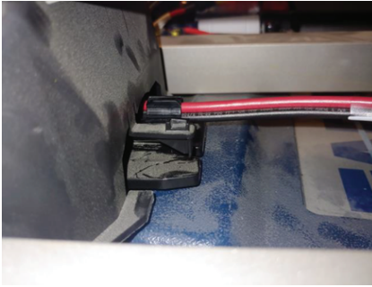
Şekil 8 – Konektörü kaviteye ittirin
