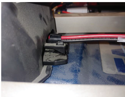
Figure 8 – Enfoncez le connecteur dans la cavité
