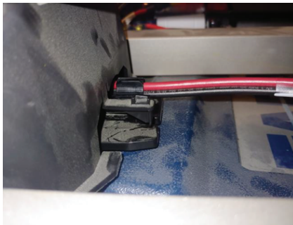
Joonis 8 – Lükake konnektor süvendisse
