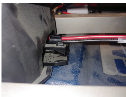
Obrázek 8 – Zatlačte konektor do dutiny
