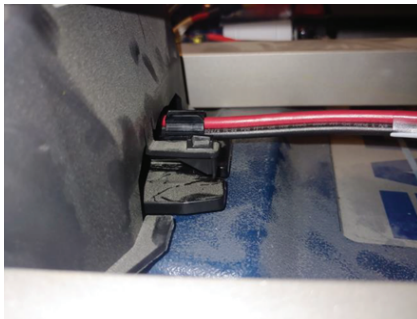
Figura 8 – Empuje el conector en la cavidad
