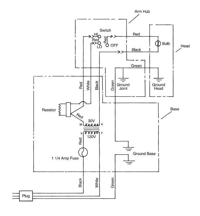
120 VOLTS, 60 Hz, 1 1/4 AMP RATING 105 TO 135 VAC OPERATING RANGE
