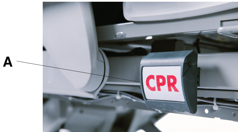
Figure 16 – Activation de la poignée de débrayage pour position d'urgence RCP
