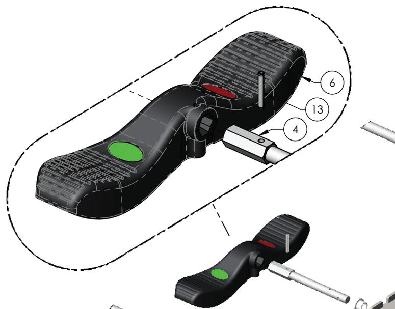
Figure 2 – Remplacement la pédale d'enclenchement du frein
