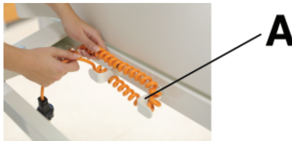
Figura 6 – Almacenamiento del cable de alimentación
