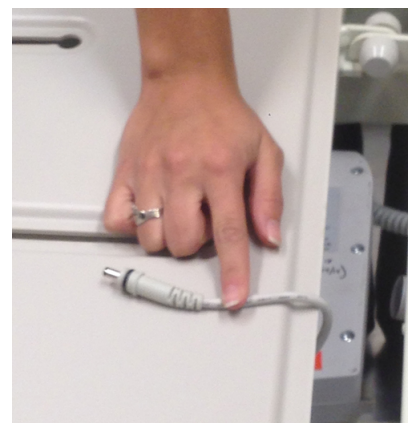
図 5 – コントロールボックスからバッテリーケーブルを抜き去る
