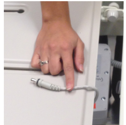
pav. 5 – Baterijos kabelio atjungimas nuo valdymo dėžės
