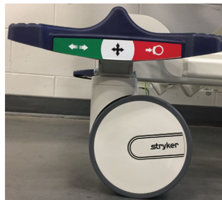
Figur 8 – Koble ut bremsene
