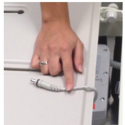
Figur 5 – Koble batterikabelen fra kontrollboksen
