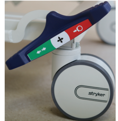
Figura 9 – Acționarea pedalei de direcție
