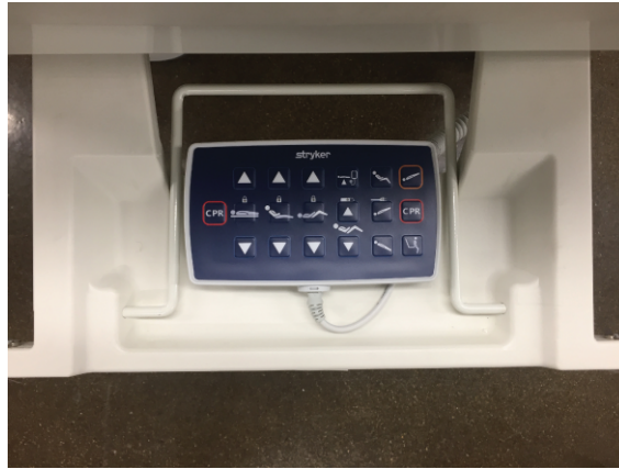
Figura 21 – Depozitarea casetei suspendate cu butoane de comandă pentru asistenta medicală
