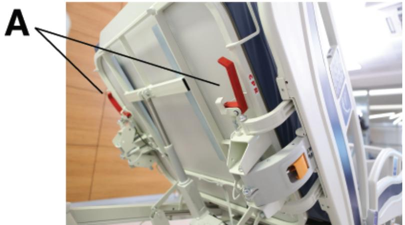
Рисунок 13 – Рычаг перевода изделия в положение для СЛР
