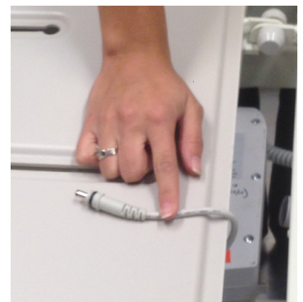
Slika 5 – Odklop kabla akumulatorja iz kontrolne enote
