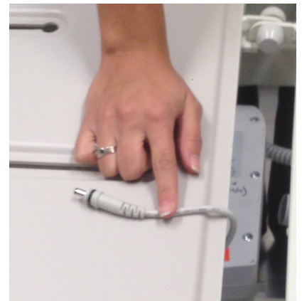
Figur 5 – Batterikabeln kopplas bort från kontrollboxen
