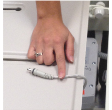
Şekil 5 – Batarya kablosunun fişini kontrol kutusundan çekme
