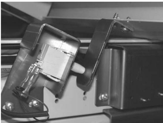
4. Étant donné que le support de ce micro interrupteur possède des trous oblongs pour régler sa position, nous allons positionner la section de cuisse afin qu'il soit simple d'obtenir la position de montage correcte pour ce support.
