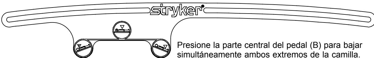
Presione la parte central del pedal (B) para bajar simultáneamente ambos extremos de la camilla.
