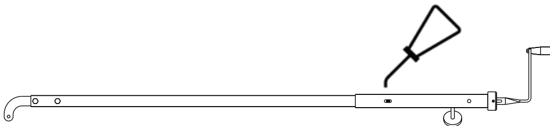
Rysunek 16 – Smarowanie śruby korby
