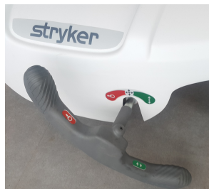
Slika 5 – Papučica za kočenje i upravljanje
