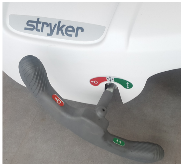
Rysunek 4 – Pedał hamulca/sterowania
