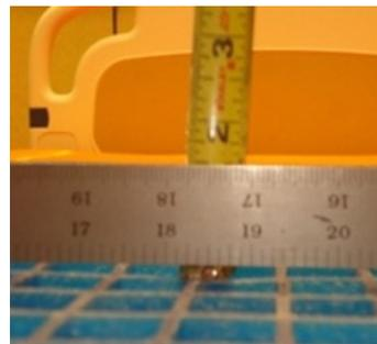
**Figure 5 – Mesurer la profondeur maximale**
