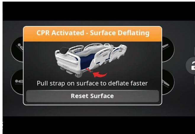
Рисунок 13 – Сообщение на экране при ненатянутом ремне для СЛР
