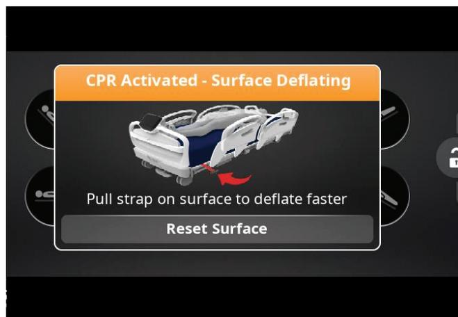
**Abbildung 10 – CPR aktiviert - Auflage wird entleert**
