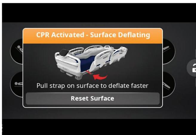
図 13 – CPRストラップが引かれていない場合に表示する
