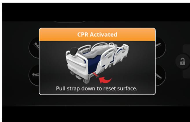
Figur 12 – Vis, når der er trukket i CPR-stroppen
