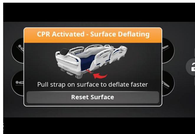
**Figura 10 – RCP attivata - Sgonfiaggio superficie**
