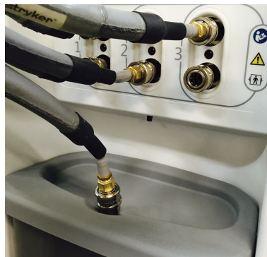
Figure 2-30 : Extrémité du tuyau du bas dans le couvercle du réservoir
