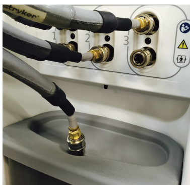
Fig. 8-32: Enden på den nederste slange i låget på vandbeholderen
