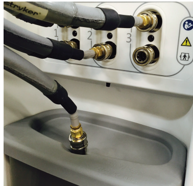
Figura 5-30: Extremidade da mangueira inferior na tampa do reservatório
