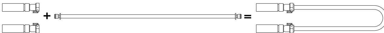
Obrázek 13-26: Hadice s konektorem typu Colder připojená k hadici s adaptérem pro servisní zařízení
