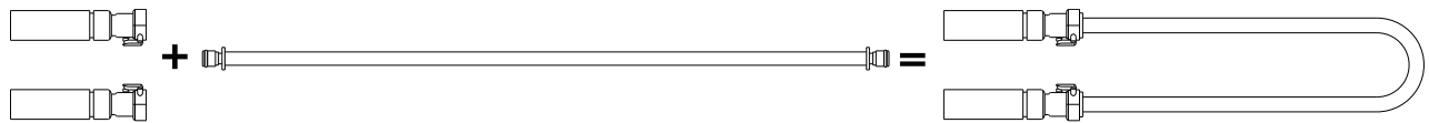
図15-26: ツールアダプターホースに接続されたColder型コネクターホース
