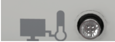
그림 16-8: 환자 체온 측정 포트
