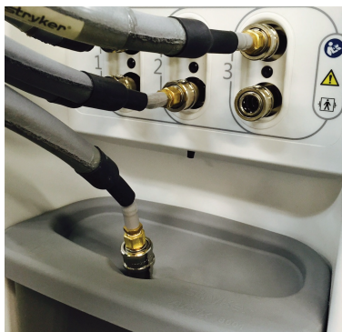
Рисунок 12-32: Конец нижнего шланга в крышке резервуара
