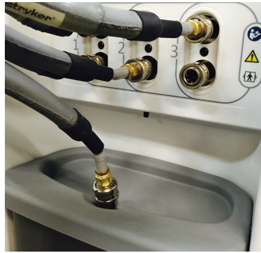
图14-30: 位于贮液筒盖子内的底部软管末端
