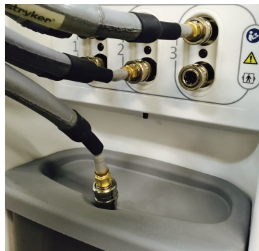
Rysunek 10-32: Końcówka dolnego węża w pokrywie zbiornika
