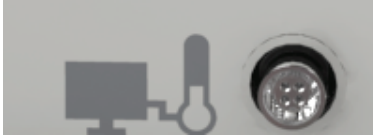
Fig. 8-8: Port til patienttemperaturoutput
