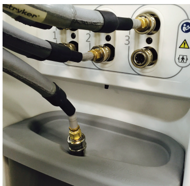
Figura 4-32: Extremo de la manguera inferior en la tapa del depósito
