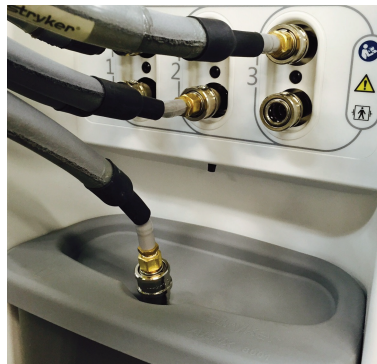
Figura 4-30: Extremo de la manguera inferior en la tapa del depósito
