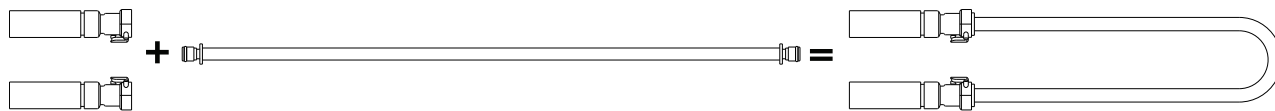
Figure 2-26 : Tuyau connecteur de type Colder raccordé à un accessoire de tuyau adaptateur
