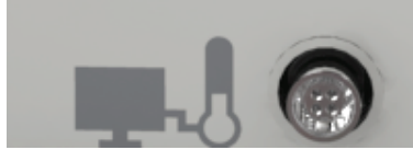
Figura 6-8: Porta di uscita temperatura paziente
