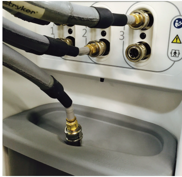
Şekil 11-32: Rezervuar kapağında alt hortum ucu
