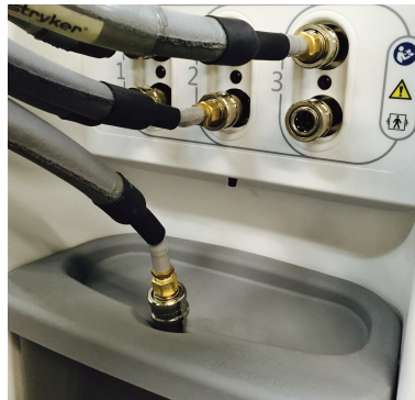
図15-32: 貯水タンクの蓋に繋がっている下部ホースの端
