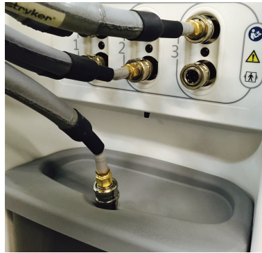
Figure 2-32 : Extrémité du tuyau du bas dans le couvercle du réservoir
